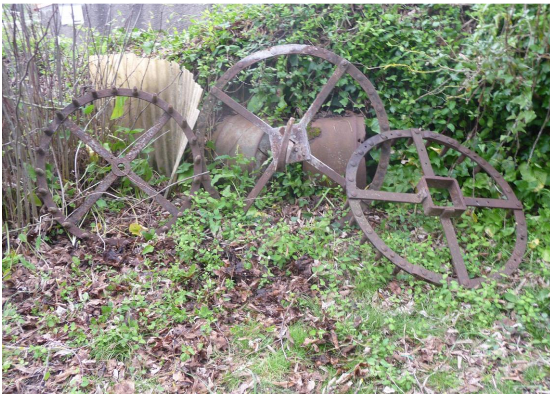
As três rodas superiores, que ficavam em posição horizontal, na pirâmide da base. Destas, falta apenas a roda maior, que ficava na base e era a roda de alcatruzes de uma nora aérea.
