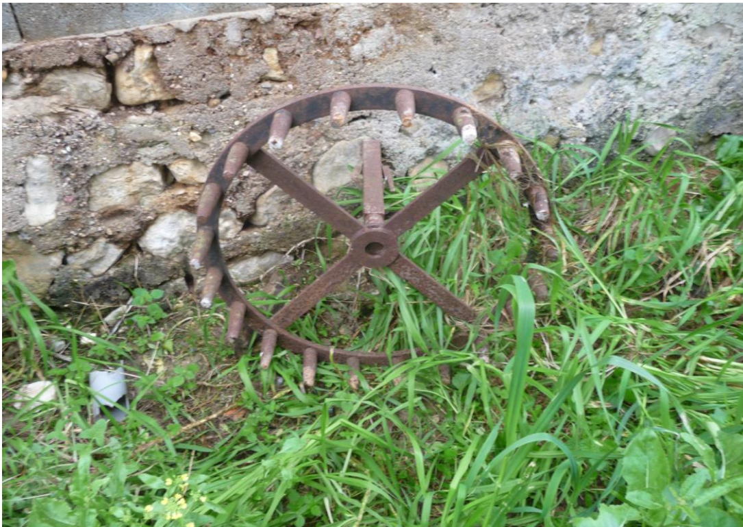
A roda que fazia contrapeso à primeira, no outro topo trave de madeira.
