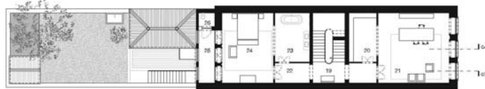
PLANTA PISO 1 19. PATAMAR ESCADA | 20. ANTE-CÂMARA | 21. ESCRITÓRIO | 22. ANTE-CÂMARA | 23. SALA DE BANHO | 24. QUARTO | 25. VARANDA | 26. L.S.
