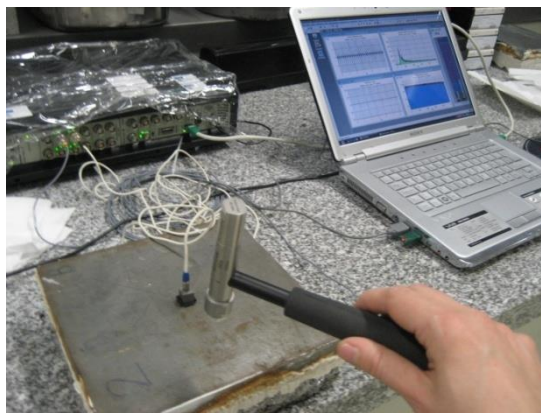
Figura 5.9 - Dispositivos de ensaio para a determinação experimental da rigidez dinâmica.
