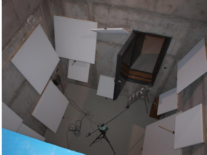
Figura 4.9 – Câmara vertical fixa após a correção dos tempos de reverberação.
