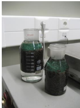
Figura 2.3 - Picnômetros usados para determinar a massa volúmica e absorção de água do ECG.
