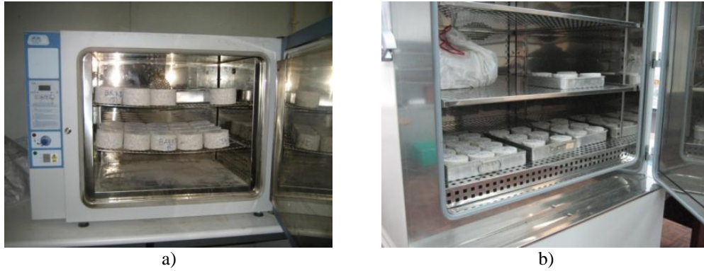
Figura 3.11 - Procedimento preparatório do ensaio de permeabilidade ao vapor de água, de acordo com a norma EN ISO 12572:2001 [78]: a) Secagem em estufa; b) Condicionamento em câmara climática ( T=23\pm 2^{\circ}\text{C} e \text{HR}=50\pm 5\% ).
