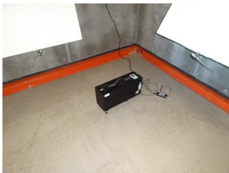
a) Interior da câmara com máquina normalizada de sons de percussão.
