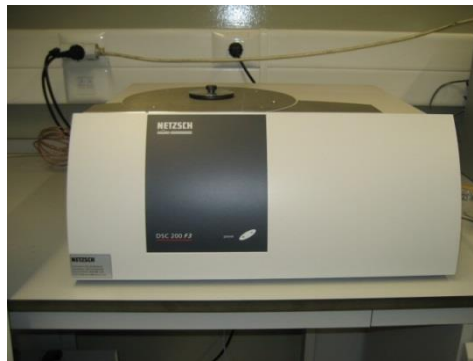
Figura 6.2 – Equipamento usado para a determinação experimental do calor específico de materiais homogêneos (Netzsch, modelo DSC200F3).
