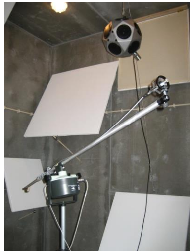
b) Interior da câmara com fonte normalizada de sons aéreos suspensa e microfone móvel.
