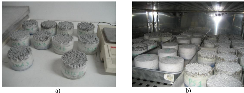
Figura 3.14 - Ensaio de permeabilidade ao vapor de água, de acordo com o método das tinas: a) Preparação dos provetes das argamassas BetArgExp; b) Provetes no interior da câmara climática.
