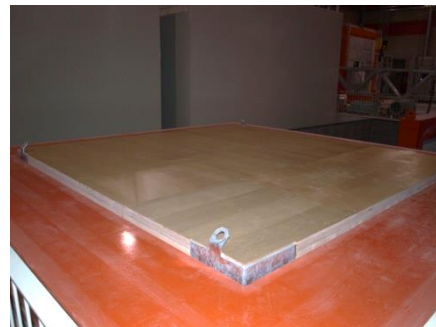
b) Provete instalado sobre a câmara fixa.
