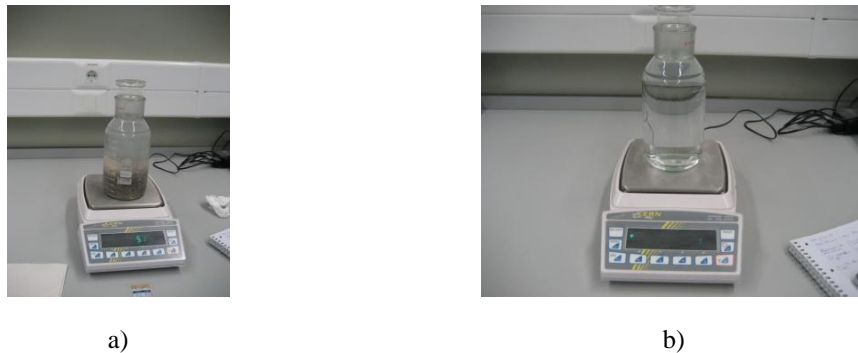
Figura 2.2 - Picnómetro e balança electrónica usados para determinar a massa volúmica e absorção de água da areia branca: a) Pesagem do picnómetro com água e agregados; b) Pesagem do picnómetro com água.
