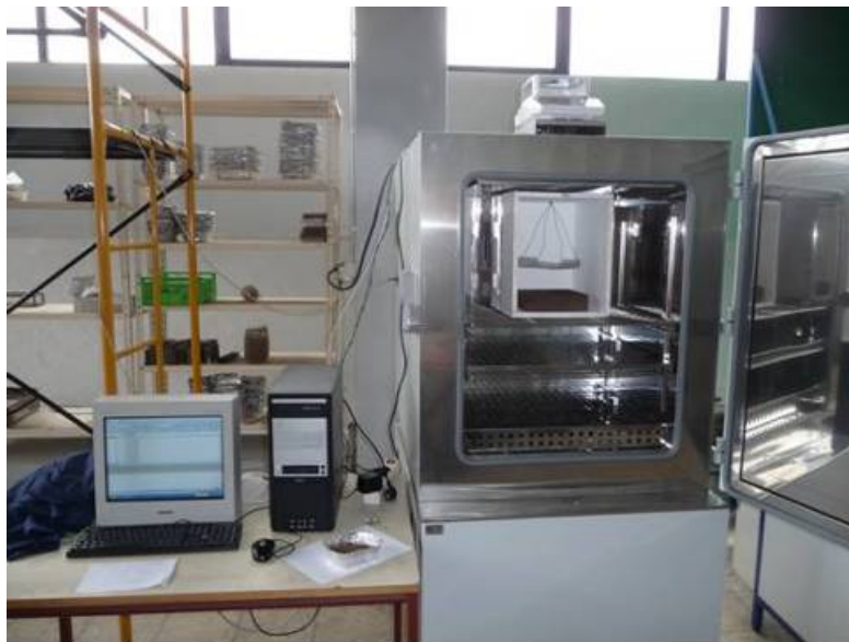
Figura 6 – Câmara climática, balança de precisão e sistema de aquisição de dados
