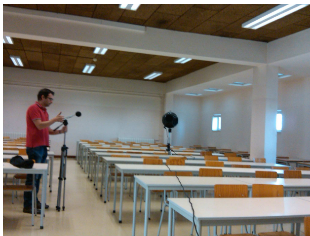
Figura 3.12 - Ensaio de determinação do tempo de reverberação.
