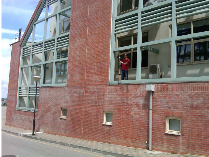
Figura 3.13 - Ensaio de determinação do isolamento acústico da fachada.
