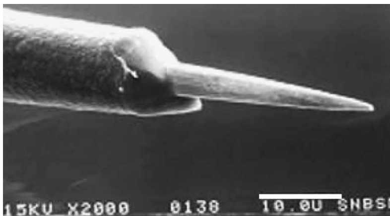
Figura 1.16 – Micrografia de SEM da ponta de um elétrodo metálico, isolado com um revestimento de Paralyne C® com 3µm de espessura [adaptado de 102] .
