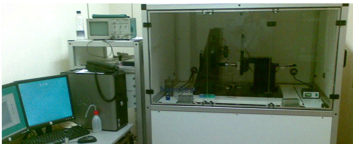
Figura 2.4- Equipamento utilizado nos ensaios de nanoindentação.
