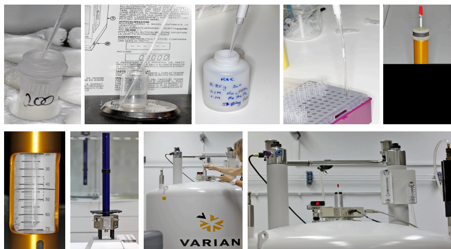
Figuras 21-29. Ilustração de alguns dos passos das técnicas de preparação e análise das amostras salivares por 1 H-RMN.
