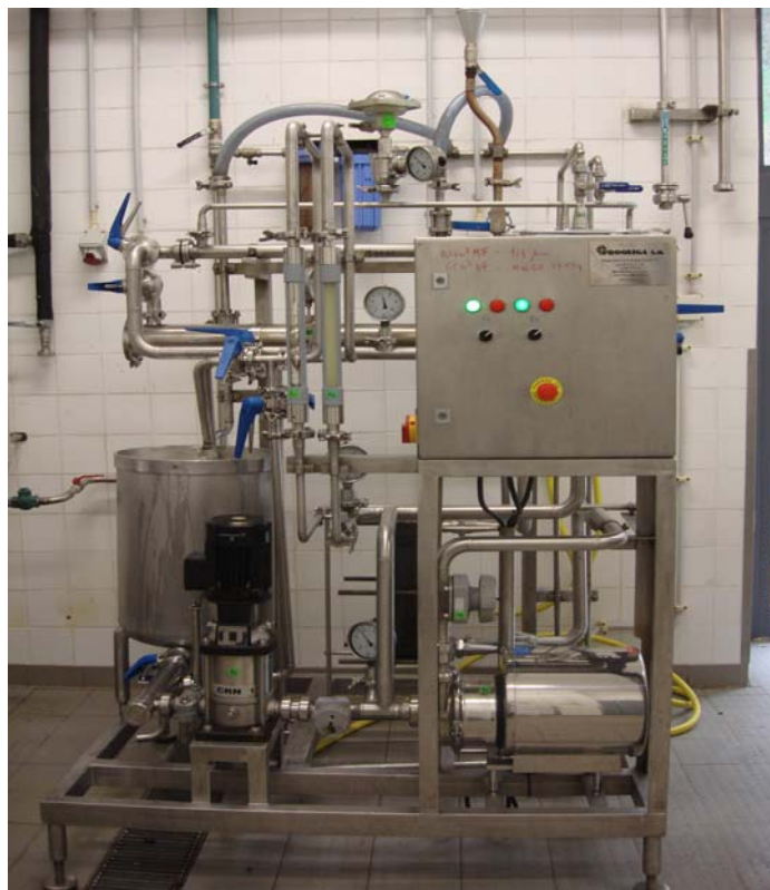
Figure 3.2. Batch ultrafiltration equipment, Escola Superior Agrária de Coimbra - Oficina Tecnológica de Lacticínios (OTL).
