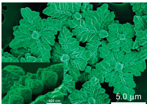
Figura 1.2 – Imagem obtida utilizando a técnica de SEM do self-assembly iônico entre o 5,10,15,20-tetra(4-(N-(2-hidroxietil)piridínio)porfirinato de zinco (II) e o hidróxido de 5,10,15,20-tetra(4-sulfonilfenil)porfirinato de estanho(IV). Adaptado de 120
