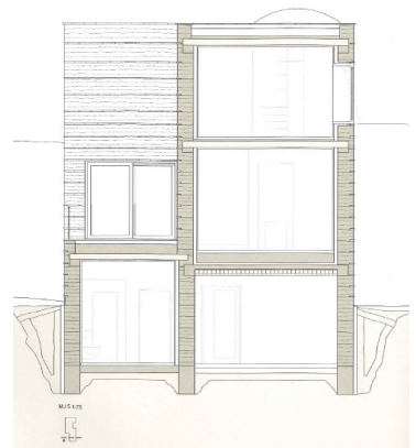
47. Proteção superior e inferior impermeáveis
