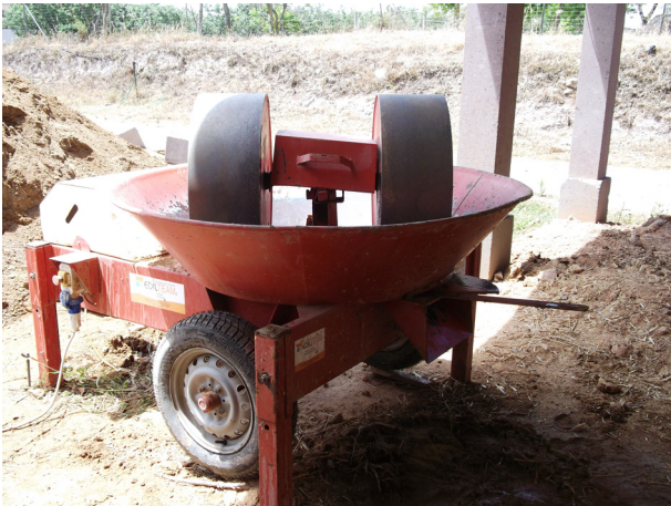
14. Misturadora de eixo horizontal, Sardenha
