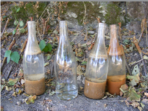
15. Teste da sedimentação-terra sedimentada, Portugal
