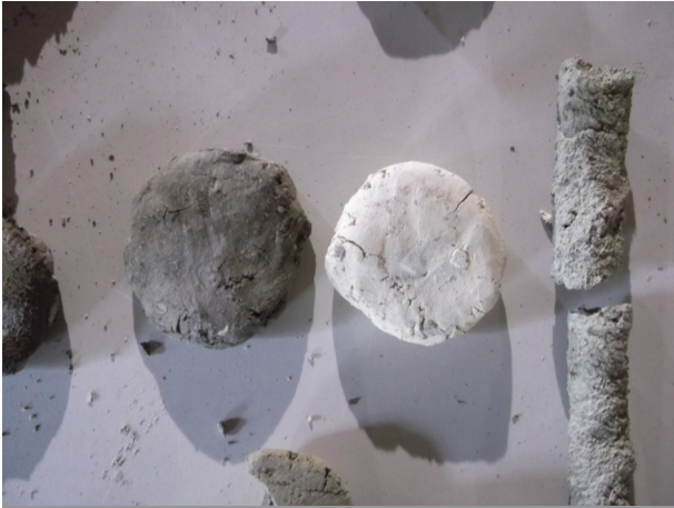
16. Teste da resistência a seco, Sardenha
