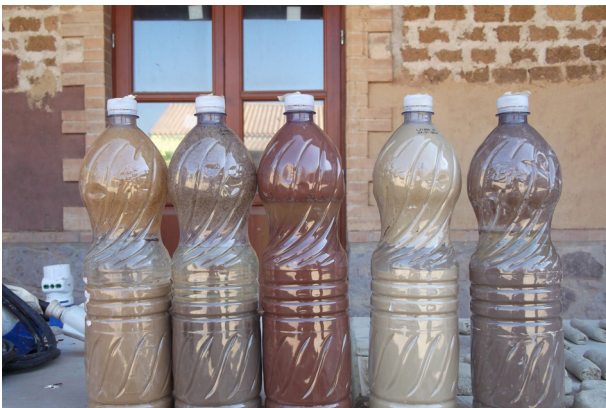
14. Teste da sedimentação - terra não sedimentada, Sardenha
