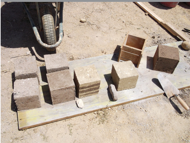
21. Provetes de terra compactada para muro de taipa, Sardenha
