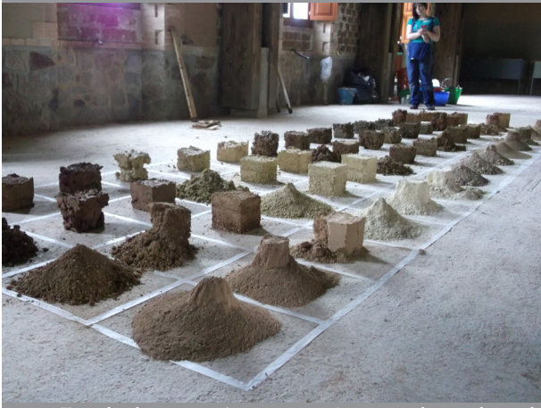
18. Teste da relação entre a água, a ação mecânica e a argila em cada tipo de terra, Sardenha
