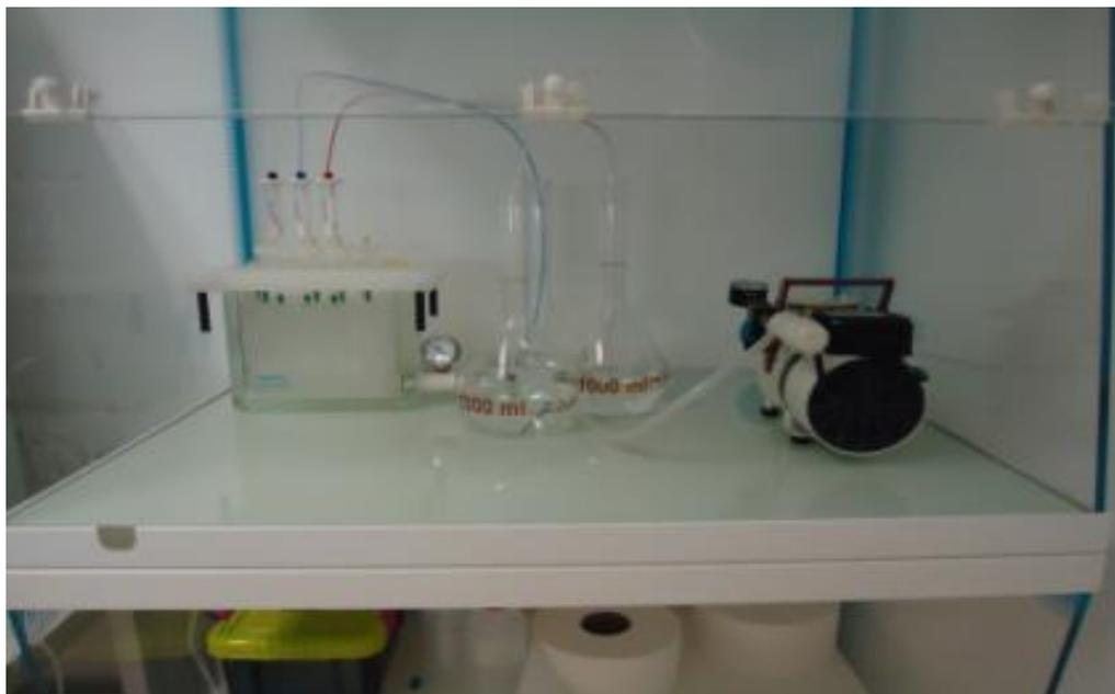
Figura 21- Sistema de vácuo utilizado na extração em fase sólida dos compostos alvo
