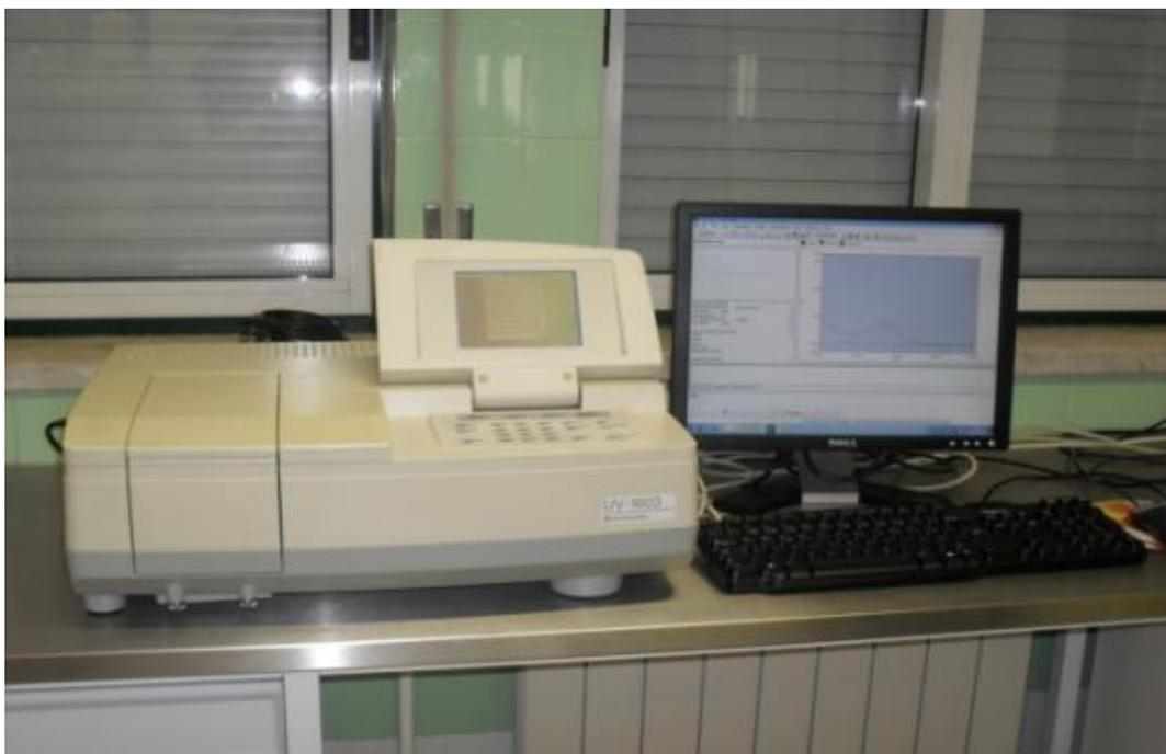
Figura 11 – Espectrofotômetro de feixe duplo utilizado neste estudo
