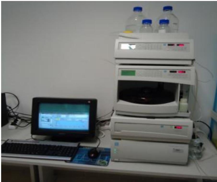
**Figura 14 - Sistema HPLC utilizado no estudo**
