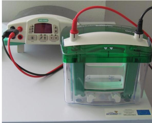
**Figura 7.** Sistema de electroforese da Bio-Rad com tina e fonte de alimentação - Mini-PROTEAN® System.
