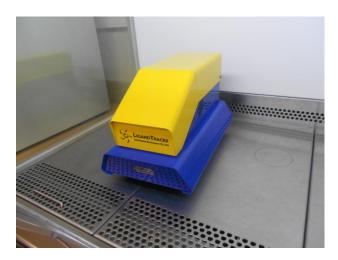
Figura 3.2 – Equipamento LigandTracer, utilizado para a realização de estudos de captação.
