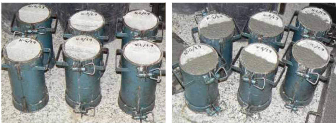
Figura 7.14 – Preparação e betonagem final dos provetes de compressão diametral.
