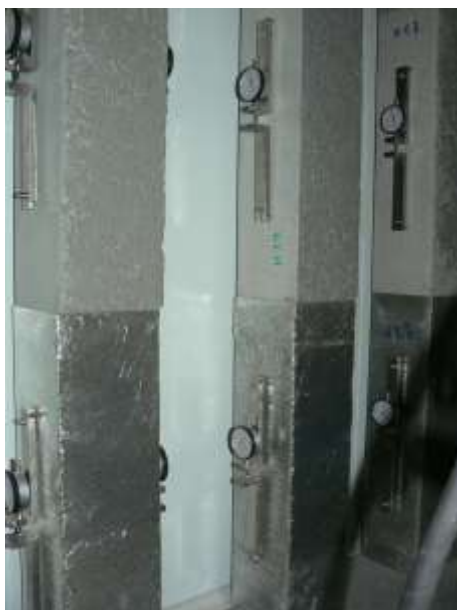
Figura 6.5 – Medição da retracção total e da retracção autogénea em provetes de BEAL.
