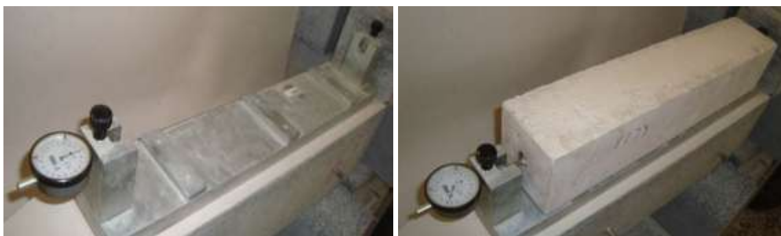
Figura 6.6 – Medição da retracção em provetes de BEALAA.
