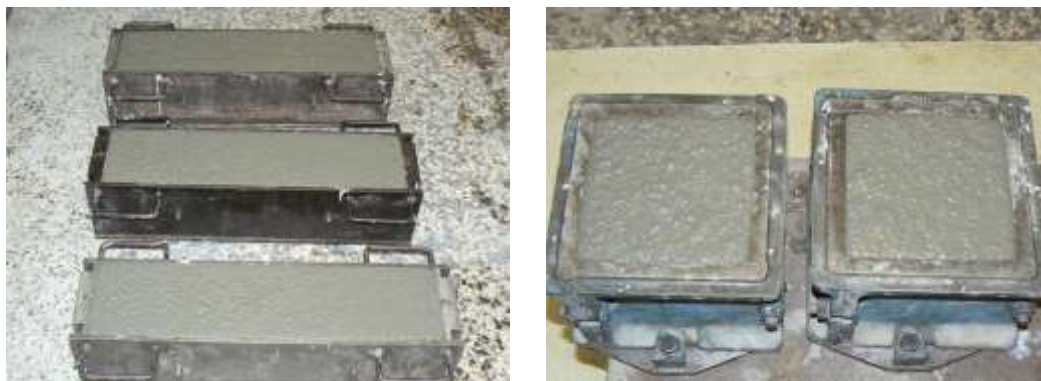
Figura 2.30 – Moldes betonados com BEAL, para caracterização dos respectivos provetes.
