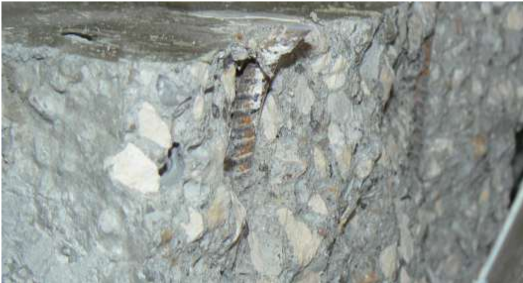
Figura 7.76 – Deformação transversal de um varão de aço na interface de corte.
