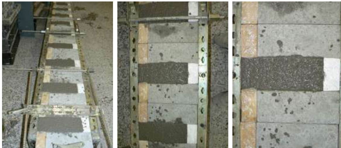
Figura 7.27 – Betonagem final dos provetes de duplo corte na interface.
