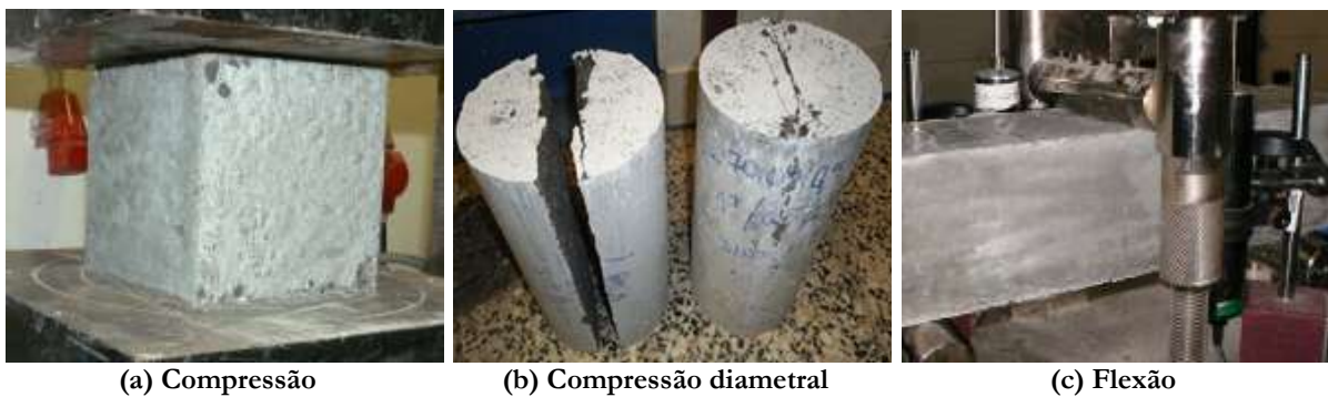
Figura 5.23 – Configuração de rotura dos provetes dos BLACRF.
