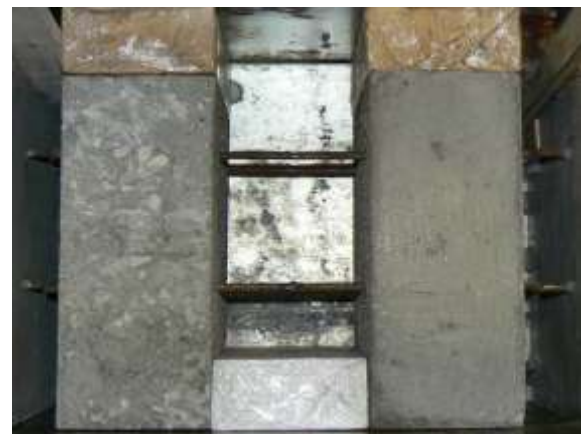
(b) substrato após a soldadura dos varões
