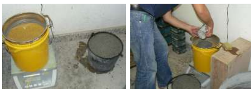
Figura 5.7 – Ensaio de resistência à segregação.
