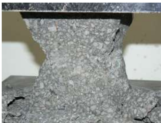
Figura 5.17 – Rotura típica de um provete de BEAL.
