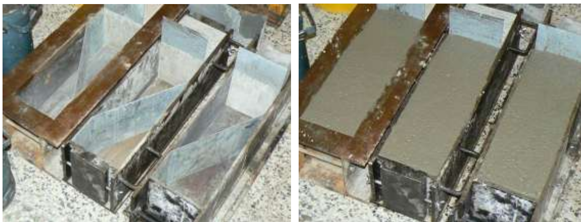
(a) moldagem com chapa quinada nos moldes
