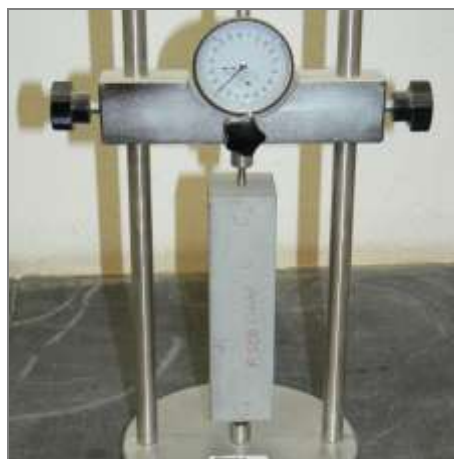
Figura 6.3 – Medição da retracção em provete de argamassa.
