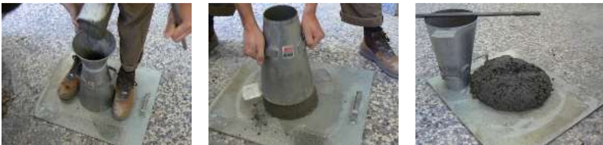
Figura 5.4 – Ensaio de abaixamento com o cone de Abrams ( slump test ).
