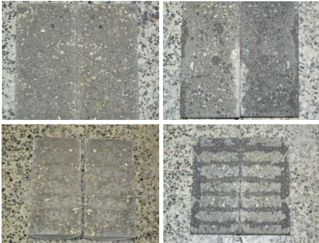
Figura 7.36 – Rotura adesiva da interface por compressão diametral.
