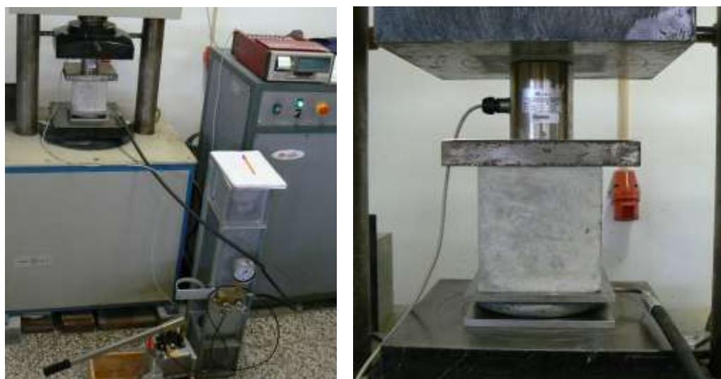
Figura 6.9 – Ensaio de calibração entre a pressão no sistema de fluência e a força aplicada.
