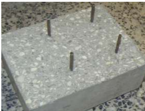
(a) substrato antes da soldadura dos varões
