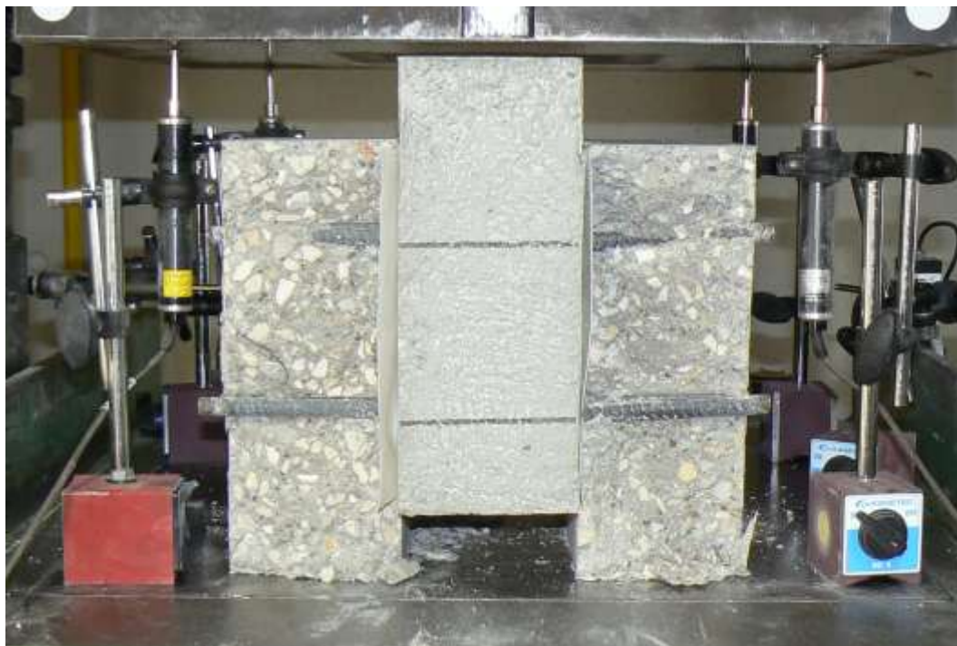
Figura 7.77 – Plano de fissura vertical no betão, no alinhamento dos varões.
