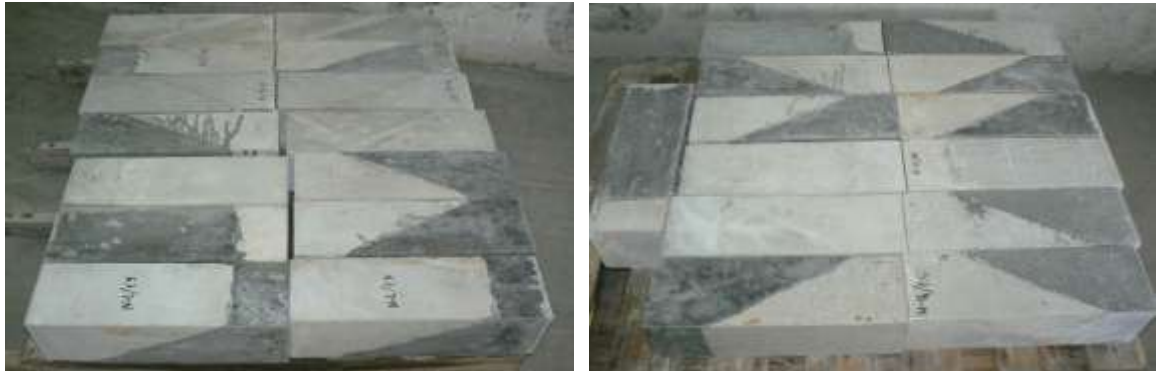
Figura 7.20 – Provetes do ensaio de corte inclinado.
