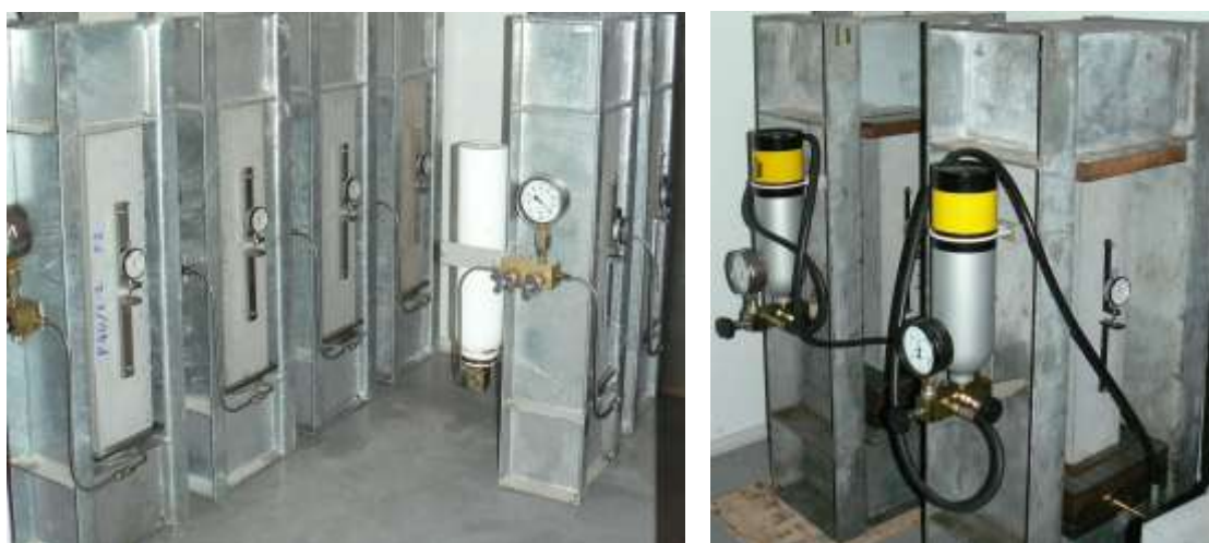
Figura 6.10 – Equipamentos com os provetes em ensaio de fluência.
