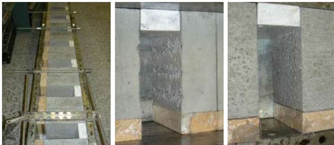
Figura 7.26 – Preparação dos provetes de duplo corte na interface para a produção final.
