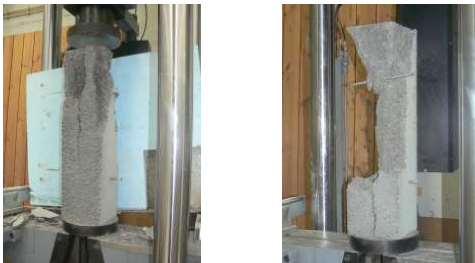
Figura 5.57 – Rotura dos provetes prismáticos de BEAL sujeitos a compressão uniforme.
