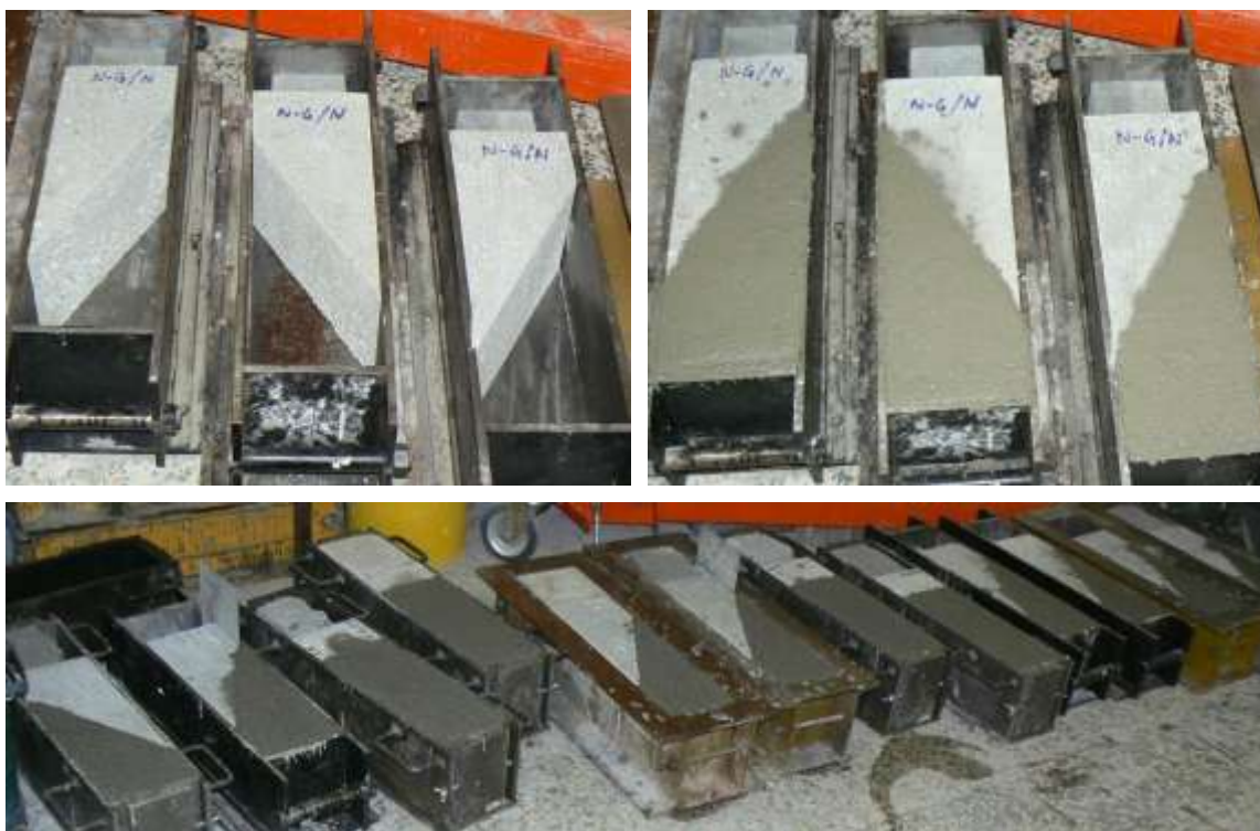
Figura 7.19 – Preparação e betonagem final dos provetes de corte inclinado.
