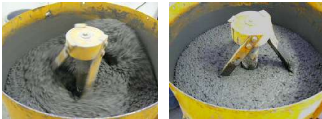
Figura 2.28 – Amassadura dos betões em misturadora de eixo vertical.
