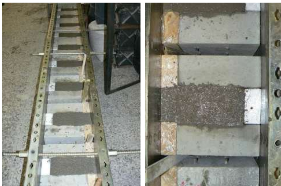
Figura 7.34 – Betonagem final provetes de duplo corte, com armadura na interface.
