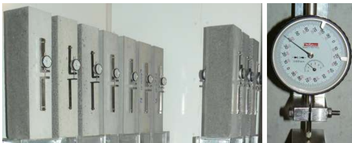
Figura 6.4 – Medição da retracção total em provetes de BEAL.
