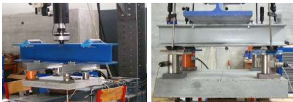
Figura 5.13 – Ensaio de punçoamento das lajetas de BLACRF.
