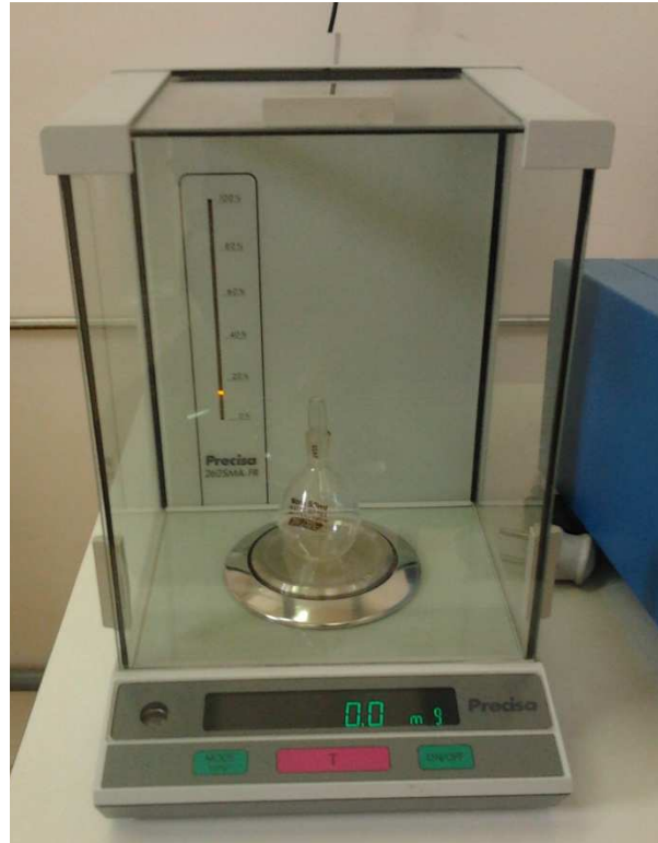
Fig. 3.25 – Balança Precisa utilizada no processo de determinação da densidade dos combustíveis.
