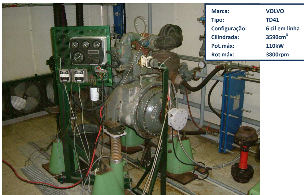
Fig. 4.3 – Montagem do motor Volvo TD41 no banco de ensaios de motores.
