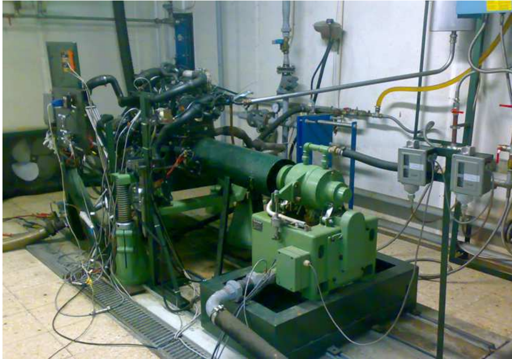
Fig. 4.36 – Banco de ensaios de motores com o motor VW 1.9 TDI instalado.
