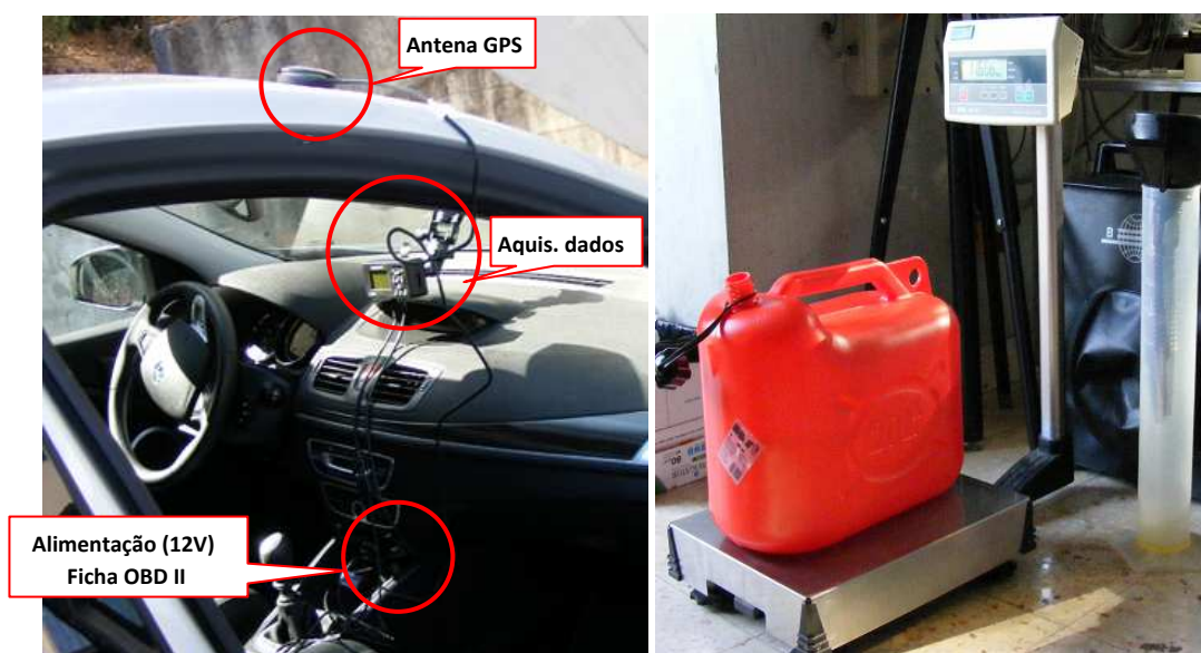
Fig. 4.28 – Utilização dos equipamentos nos ensaios em estrada (aquis. Dados por OBD + GPS na imagem da esquerda e pesagem de reservatórios de combustível na imagem da direita).
