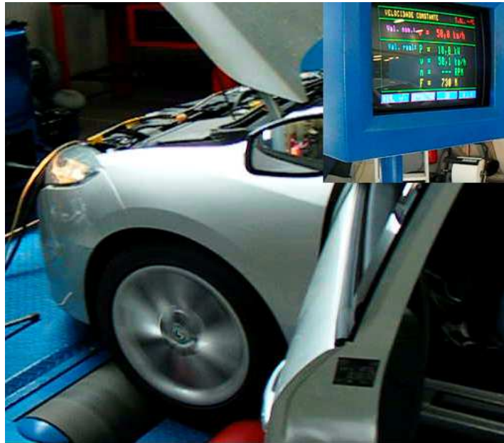
Fig. 4.26 – Imagem da realização de ensaios em banco de rolos
