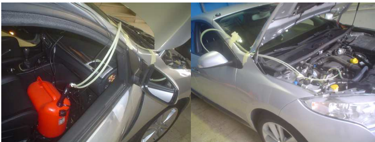
Fig. 4.29 – Imagem onde é possível identificar as ligações efetuadas na alteração do circuito de combustível, permitindo o abastecimento e retorno do combustível ao reservatório utilizado.
