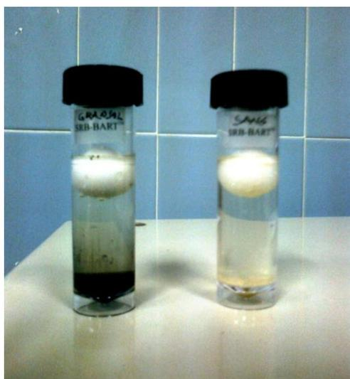
**Figura 9.6** – Testes à presença de bactérias redutoras de sulfato usando os biodetectores BART™. O tubo enegrecido revelou-se positivo à detecção.
