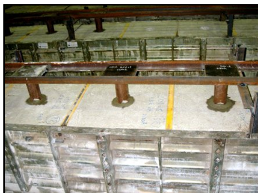
h) Selagem das micro-estacas
