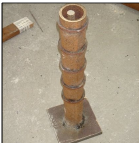
c) Micro-estaca de tubos texturados (Fase II)
