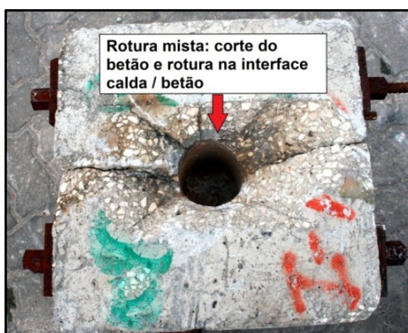
b.3) Rotura observada no ensaio BT-TT-17
