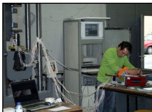
b) Ligação dos extensômetros ao data logger
