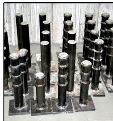
d) Aspetto final das micro-estacas
