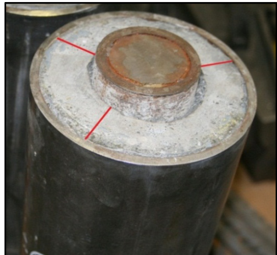
b) Micro-estaca selada em tubos de aço
