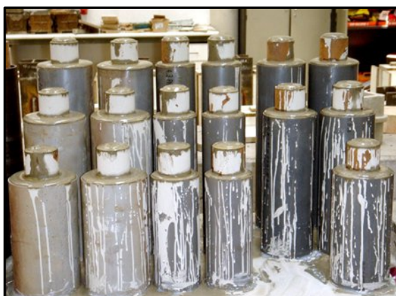
d) Selagem das micro-estacas
