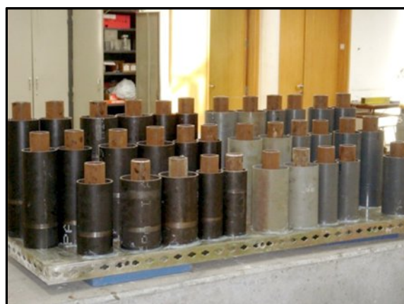
b) Colagem das micro-estacas e dos tubos de confinamento
