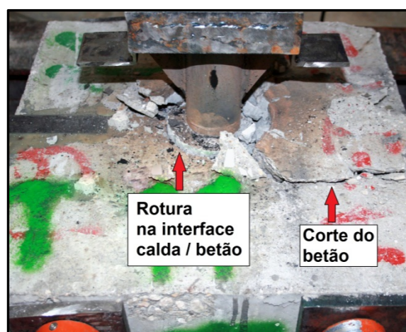
b.4) Rotura observada no ensaio BT-TT-9
