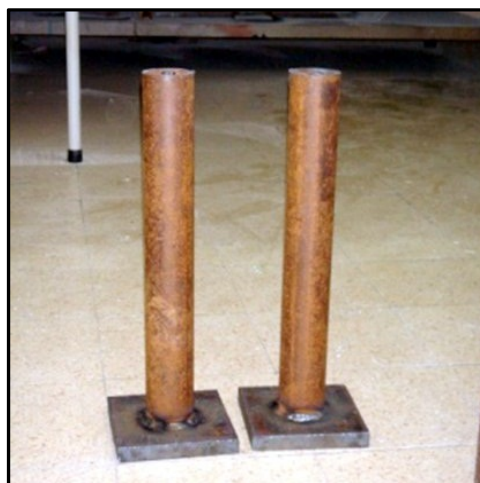
b) Micro-estaca de tubos lisos (Fase I e Fase II)
