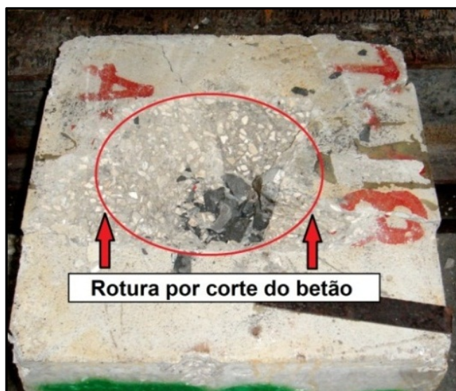
a) Modo de rotura (1): ensaio com l_b = 150 mm (BT-TT-2)
