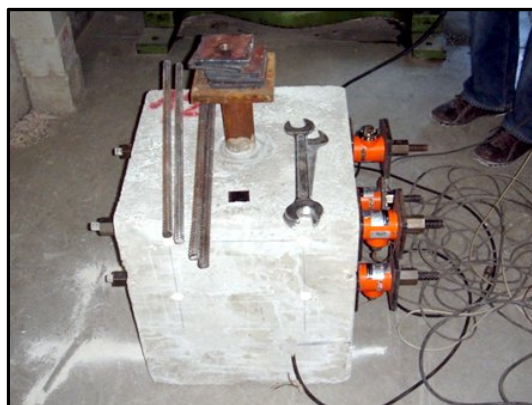
l) Blocos confinados com pré-esforço lateral (ativo)
