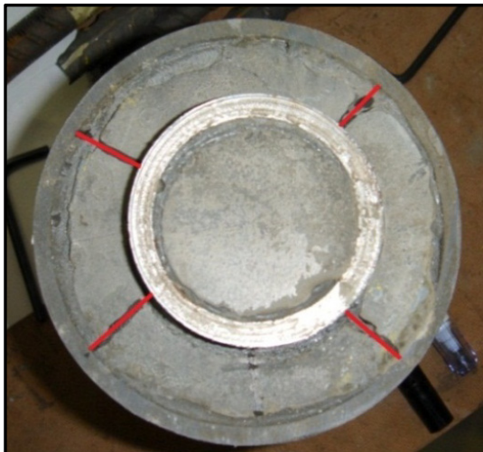
a) Micro-estaca selada em tubos de PVC
