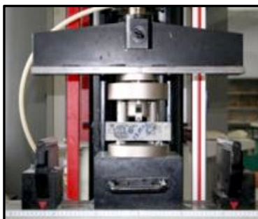
f) Ensaio de flexão
