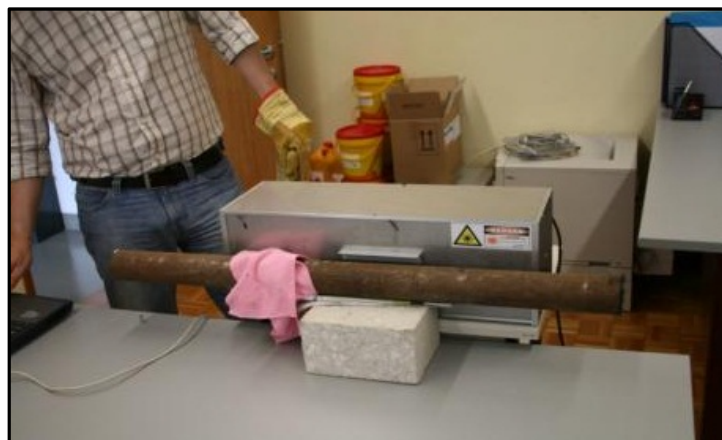
Figura A.9 – Obtenção de perfis de rugosidade com o rugosímetro laser
