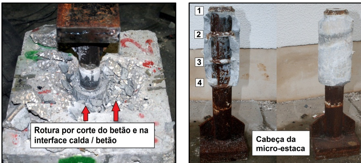
c.1) Rotura observada no ensaio BT-TT-14
