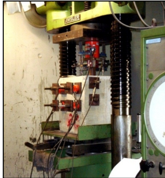
b) Ensaio com micro-estaca de tubo texturado
