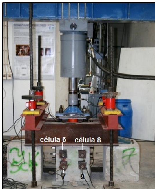
f) Ensaio com micro-estaca de tubo texturado
