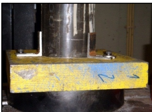
a) Colocação do provete no prato de fundo
