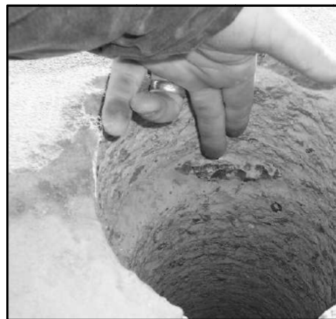
b) Superfície rugosa - carotagem por percussão (Gómez et al. , 2005)
