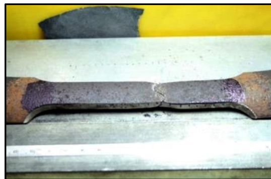
b) Marcação e divisão em partes de L_o
