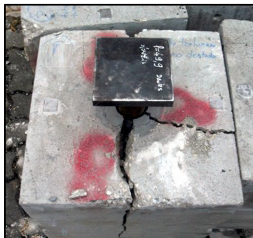
b) Modo de rotura (2): ensaio BT-TT-12
