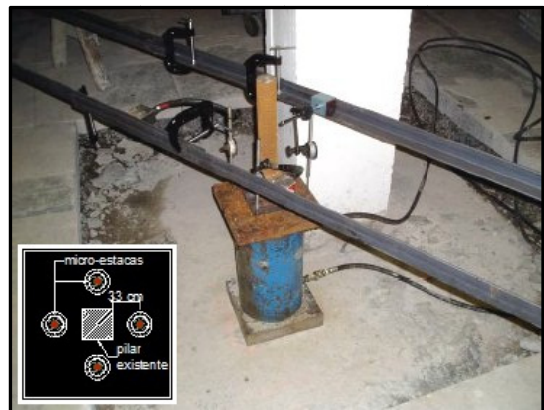
b) Ensaio de tração
