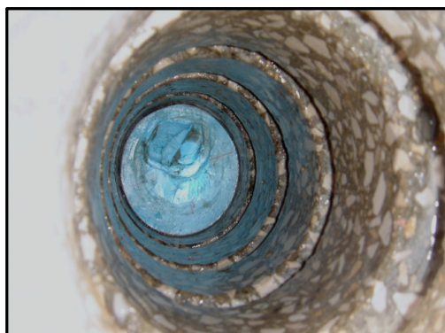
f) Furo com superfície indentada
