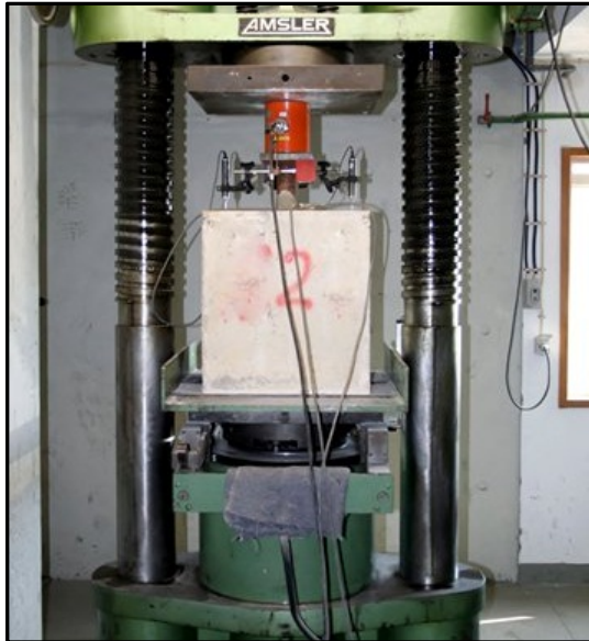
a) Ensaio com micro-estaca de tubo liso
