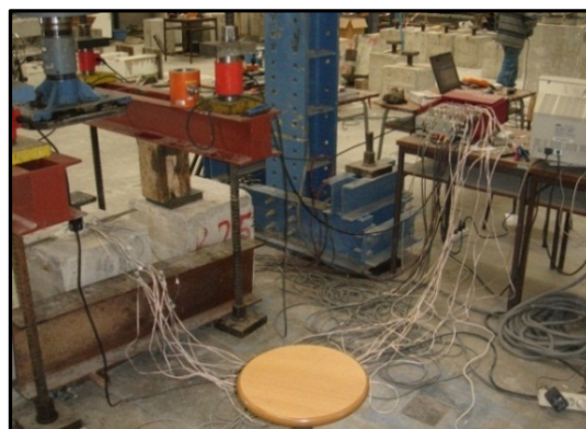
d) Ligação dos extensómetros ao data logger
