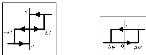
Fig. 14 – Representação esquemática dos controladores de histerese do binário (controlador de três níveis) e do fluxo estatórico (controlador de dois níveis)<sup>45</sup>.
