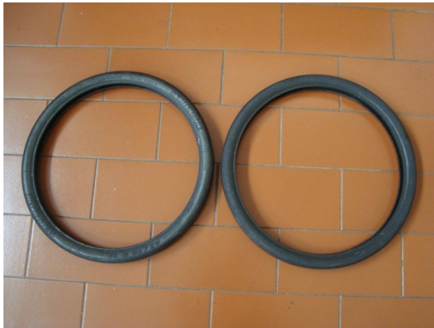
Figura 6.1. - Pneus MICHELIN 45/75 R16 usados durante os ensaios, em que se pode verificar que o pneu do lado direito já tem as inscrições removidas.
