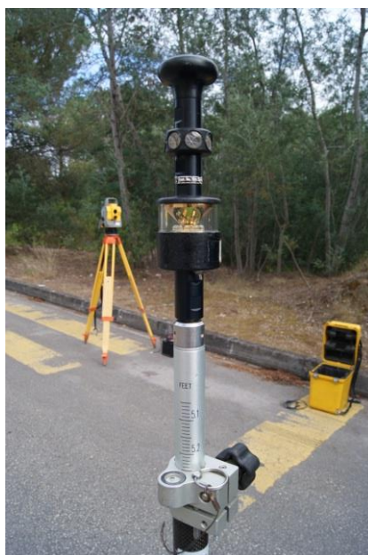
Figura 4.1. - Estação Total "Trimble 5605 DR200+" usada para o levantamento topográfico por cortesia da GeoDouro
