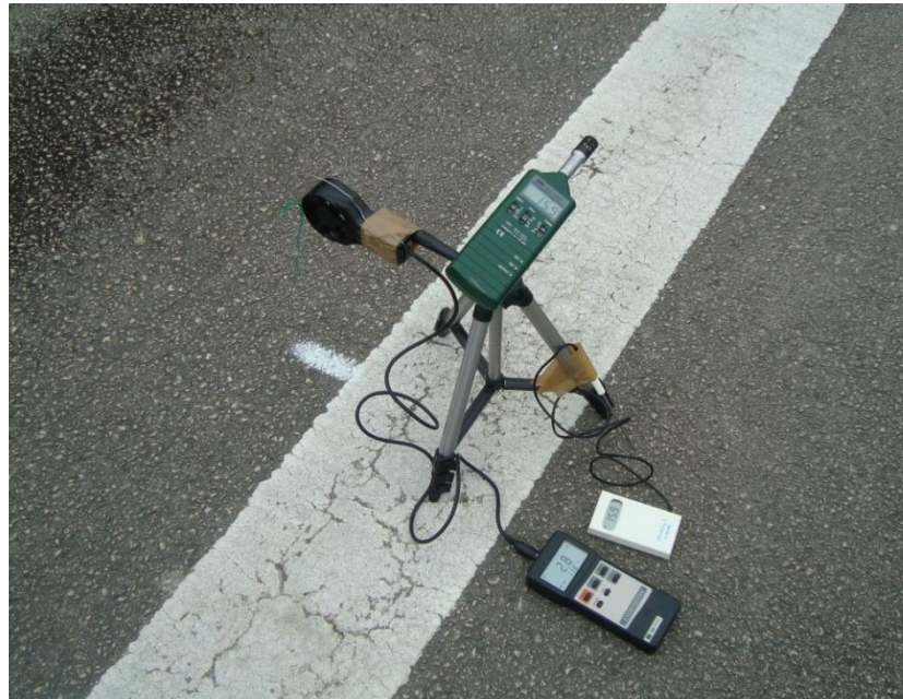
Figura 7.1. - Medição da velocidade do vento, da humidade relativa do ar e das temperaturas do ar e do pavimento.
