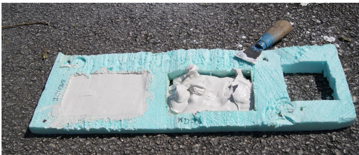
Figura 5.3. - Moldes de gesso com diferentes desmoldantes
