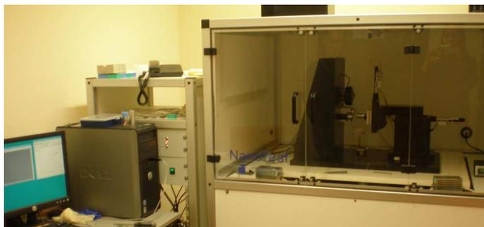
Figura 3.12. Equipamento de nanodureza, marca MicroMaterials NanoTest.
