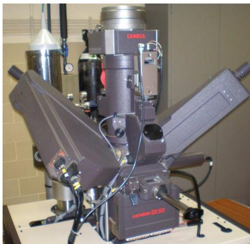
**Figura 3.5.** Microsonda utilizada da marca CAMECA (modelo SX50).
