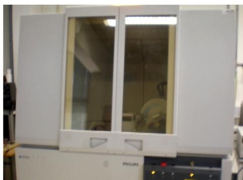
**Figura 3.14.** Equipamento de difracção de raios-x, da marca Philips (modelo X'Pert).
