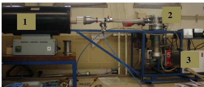
**Figura 3.4.** Forno horizontal utilizado no tratamento térmico das amostras.
