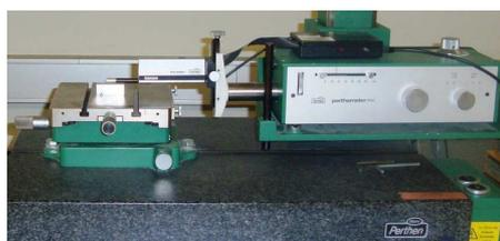
**Figura 3.6.** Rugosímetro Perthen utilizado no ensaio.
