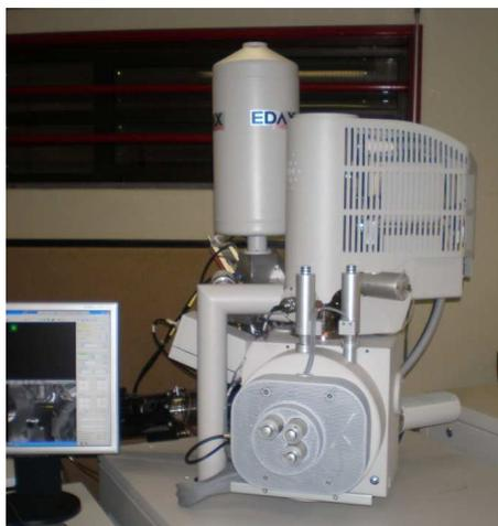
**Figura 3.8.** Equipamento de SEM, da marca Fei Quanta 400.
