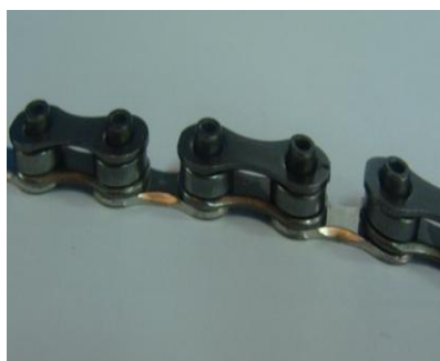
Figura 3.9 – Colocação da placa interior superior – Módulo 4
