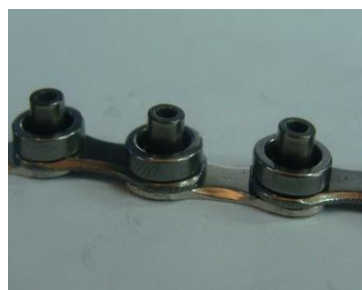
Figura 3.8 – Encaixe dos rolos nos eixos - Módulo 3
