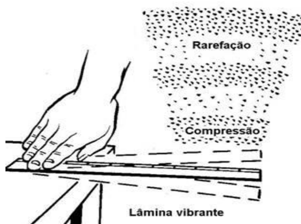
Figura 2.1 – Propagação da vibração no meio envolvente ao corpo vibrante (6)
