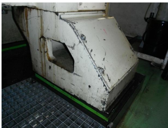
Figura 4.13 - Ilustração de um "pé" da Prensa Mecânica Minster P2H100
