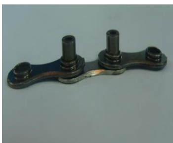
Figura 3.7 – Elo e placa interior inferior – Módulo 2
