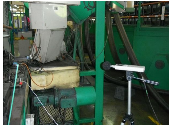
Figura 3.19 - Posicionamento do sonómetro e acelerómetro na CHC
