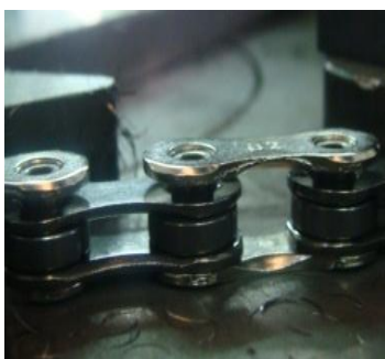
Figura 3.10 – Colocação da placa exterior superior - Módulo 5
