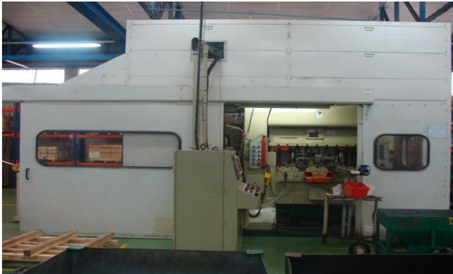
Figura 3.12 - Prensa Minster P2H100 envolta numa cabine insonorizada existente na SRAMPORT
