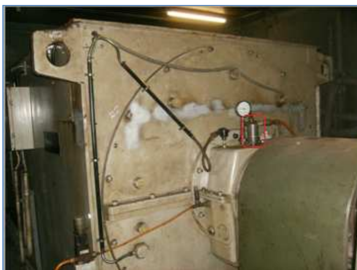
Figura 3.3. Indicação do sensor de velocidade, localizado na parte superior da chumaceira
