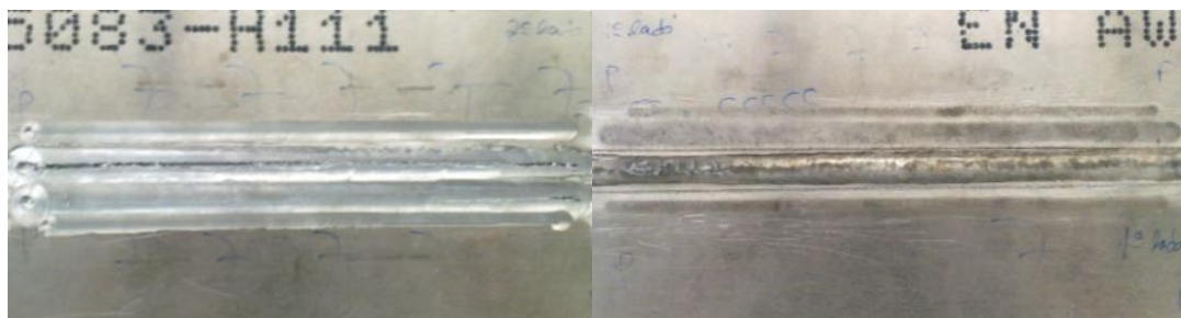
Figura 4.8: Placa nº 7 onde se nota o respectivo abatimento do material e o defeito túnel ao longo do pós-processamento
