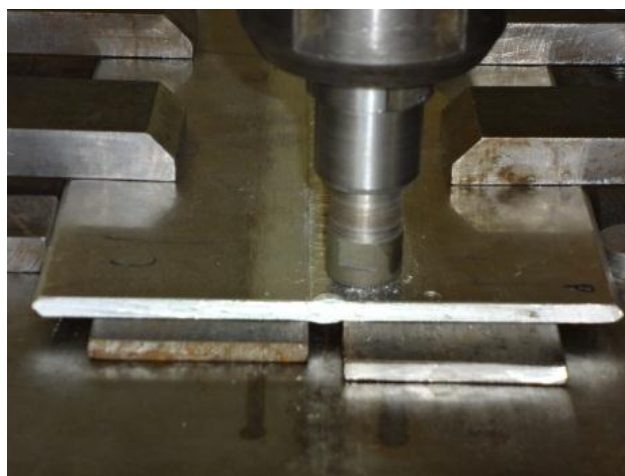
Figura 3.3: Montagem utilizada para o pós-processamento por fricção linear.
