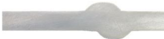
Figura 4.3: Desfasamento entre os dois cordões da soldadura MIG, na placa nº2.
