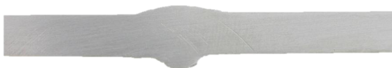
Figura 4.1: Abatimento do cordão da soldadura MIG na placa nº 3.
