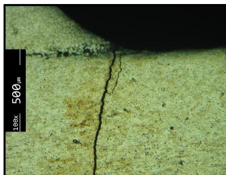
Figura 2.6: Propagação de uma fenda numa liga AA5083-H111 soldada a MIG (resultado obtido no decorrer da tese presente).
