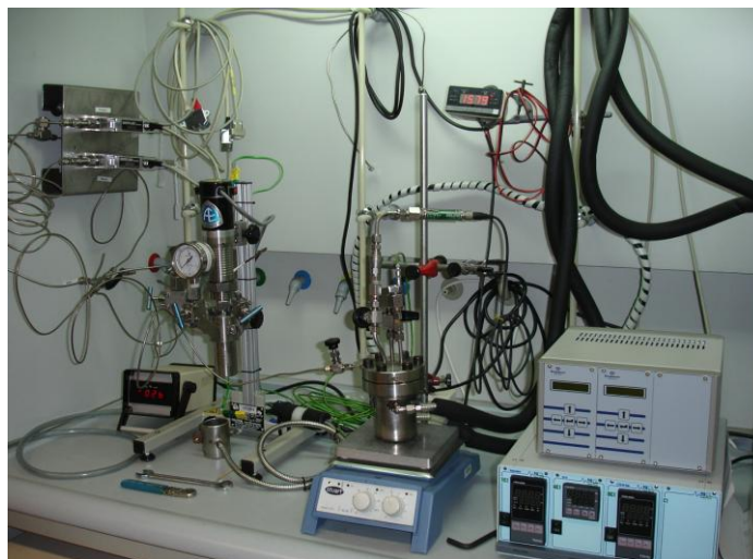
Figura 4.2- Linha de gases e reator para a reação de hidrovinição da UB
