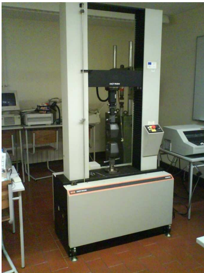
Figura 0.9. Máquina usada para os ensaios de tracção INSTRON Model 4206.
