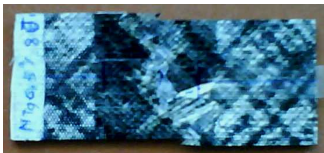
Figura 0.4. Provete com nanotubos de carbono depois do ensaio de tracção.
