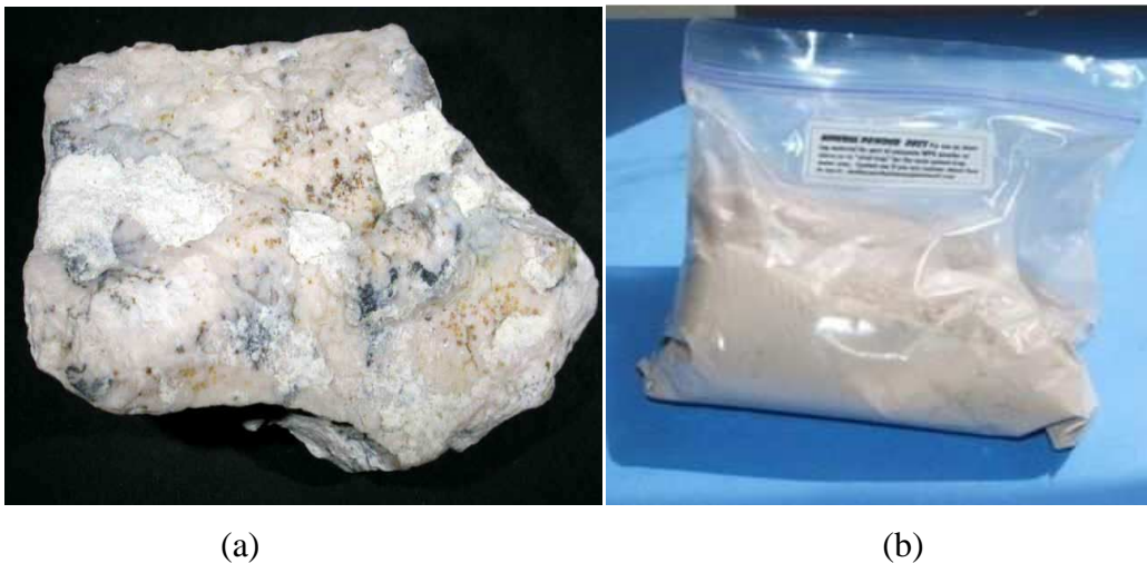
Figura 2.1. Montmorilonita : (a) em rocha; (b) depois de processada para ser misturada em resina.
