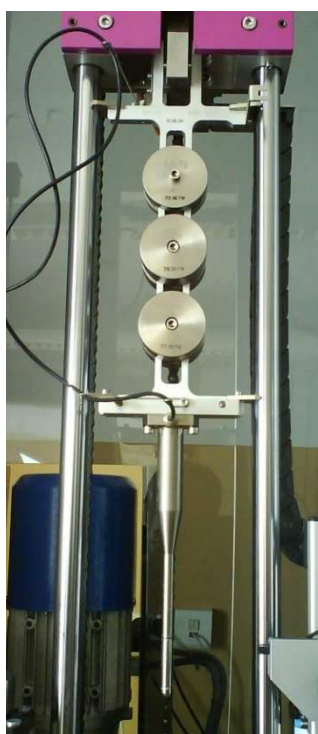
Figura 0.10. Fotografia do impactor usado. Observam-se os 6 pesos com uma massa total de 2,5 Kg. A estrutura de suporte tem uma massa de 0,5 Kg e o impactor de 0,4 Kg. O impactor tem uma ponta semi-esférica com um diâmetro de 10 mm.
