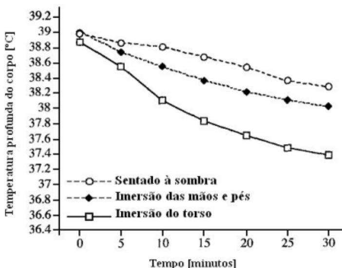
**Figura 10** – Resultados dos estudos efectuados, monitorizados e registados a cada 5 minutos, durante 30 minutos, para cada uma das estratégias de arrefecimento (Adaptado de Clapp *et al.*, 2001).
