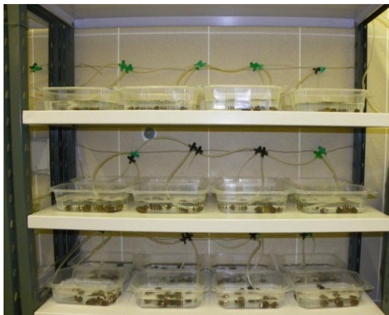
Figura IV.1 – Montagem experimental dos testes de toxicidade.
