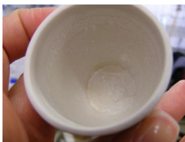
Figura 4.2- Cadinho após a evaporação de 25 ml de solução a 105 °C.
