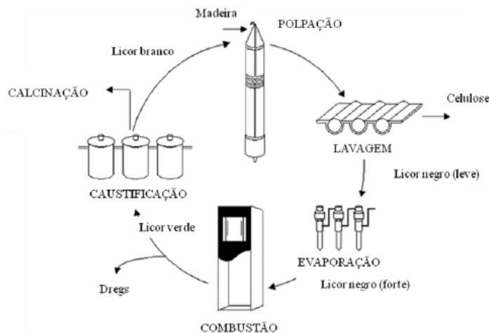
Figura 2.3- Fluxograma simplificado do processo de caustificação com a recuperação de reagentes químicos (modificada de Pöykiö et al. , 2006).
