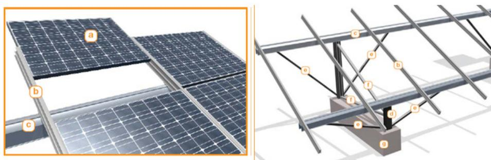
Figura A.8.12. Armação do sistema de montagem [21]
