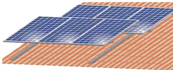
**Figura 3.7.**Montagem de um grupo de painéis FV sobre calhas, utilizando um sistema de calha-cruzada, em que a calha e a disposição dos painéis podem ser girados 90° [2]
