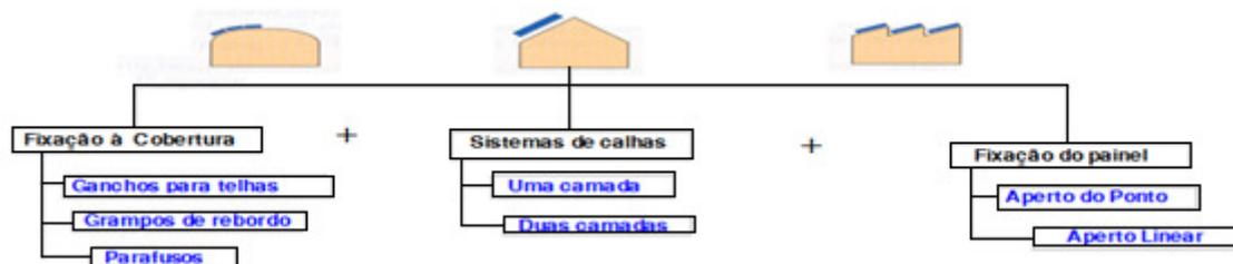
Figura 3.2 Painéis FV montados sobre coberturas inclinadas [2]
