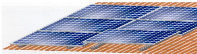
**Figura 3.5.** Montagem dos painéis FV horizontalmente sobre as calhas verticais de sustentação [2]
