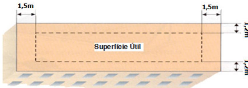
**Figura 3.15.** Distâncias dos painéis relativamente ao perímetro da superfície
