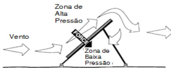
**Figura 3.16.** Zona de alta pressão ( zona onde o vento atinge a frente da superfície dos painéis) [10]
