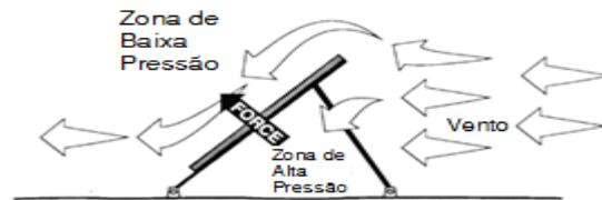
**Figura 3.17.** Zona de baixa pressão(zona à qual o vento atinge a parte da de trás da superfície dos painéis) [10]
