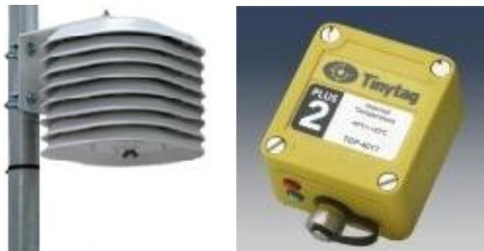
Figura 13 - Imagem dos abrigos de radiação solar utilizados e dos termógrafos Tinytag Plus 2 TGP 4500.
