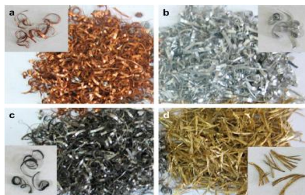
Figura 25. Ilustração das peças metálicas estudadas para melhorar a condutividade térmica; a)cobre; b)alumínio, c) aço inoxidável; d)latão; Fonte: Demir et al. (2010)
