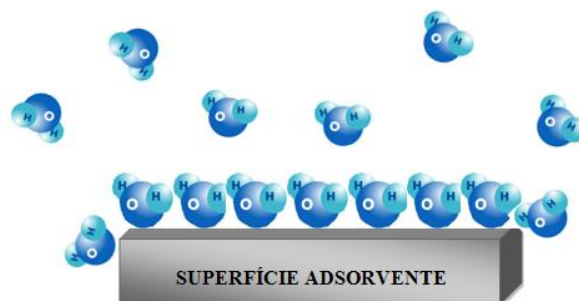
Figura 16. Retenção das moléculas de água numa superfície adsorvente.
