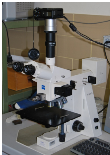
Figura 3. Microscópio óptico ZEISS Axiotech 100HD com máquina fotográfica Canon PowerShot G5 acoplada.
