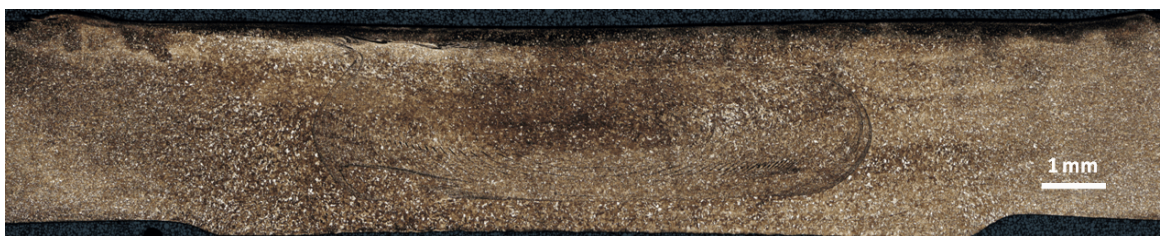
Figura 13. Falta de penetração na soldadura CuW10V10 (50x) e Onion Rings .
