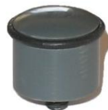
Figura 8. Ponta de prova usada nos ensaios do contacto pele-têxteis.
