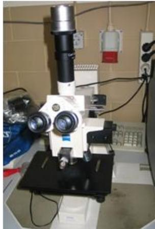
Figura 4 - Microscópio óptico Zeiss Axiootech 100 HD
