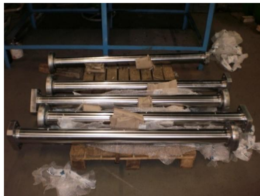
Figura 5. Hastes dos macacos mecânicos da válvula cilíndrica.
