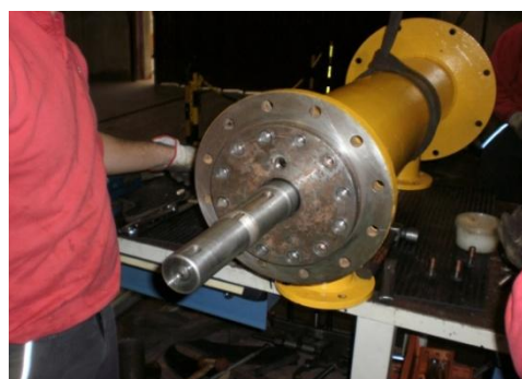
Figura 23. Acoplamento da tampa inferior da manga do macaco mecânico.
