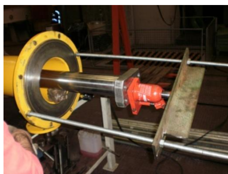
Figura 22. Introdução do conjunto haste/fuso na manga do macaco mecânico.
