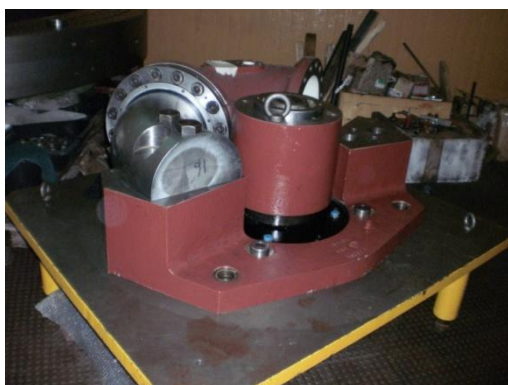
Figura 52. Montagem dos servomotores em bancada.
