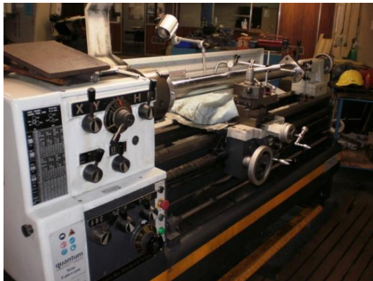
Figura 6. Controlo dimensional das hastes entre pontos, em torno mecânico.
