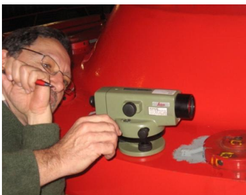
Figura 96. Nível óptico colocado na flange do veio do alternador.
