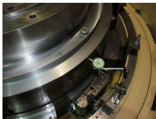
Figura 57. Ajustagem da chumaceira do alternador.
