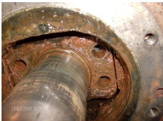
Figura 4. Flange de acoplamento entre a haste e o obturador.
