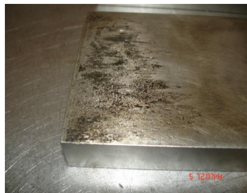
Figura 37. Mola dos patins axiais da chumaceira combinada, apresentando alguma degradação.
