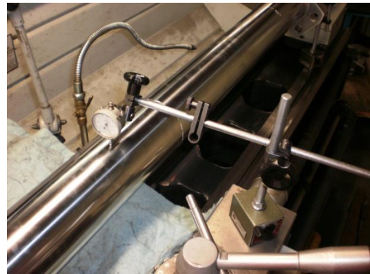
Figura 7. Verificação do empeno das hastes.
