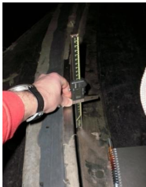
Figura 28. Medição realizada no obturador da válvula cilíndrica.
