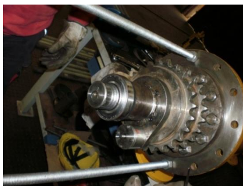
Figura 24. Montagem das cremalheiras da cadeia de sincronização no fuso de precisão.
