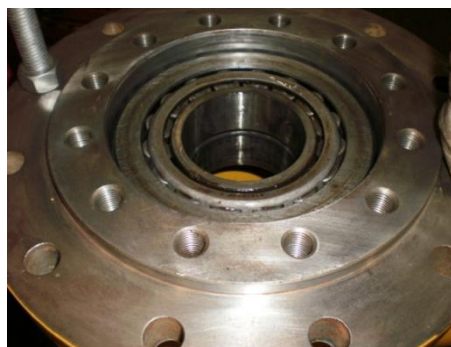
Figura 21. Introdução dos rolamentos cónicos na manga do macaco mecânico.
