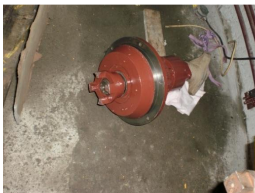
Figura 14. Acoplamento do redutor ao macaco mecânico.
