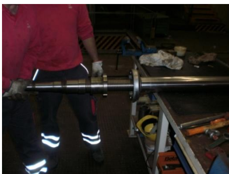
Figura 20. Colocação do fuso de precisão no interior da haste.
