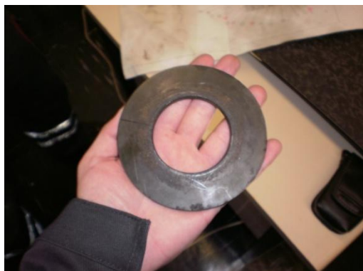
Figura 11. Anilha cónica fissurada.
