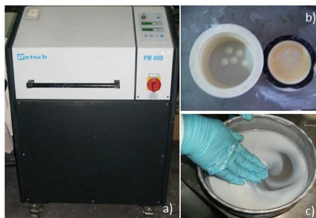
Figura 12. Moagem das lamas de anodização: a) moinho planetário, b) cuba com as esferas de alumina e o material em meio líquido e c) passagem da mistura pelo peneiro de malha 25 \mu\text{m} .
