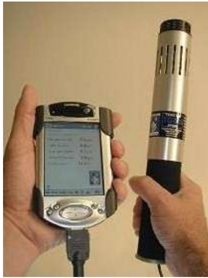
Figura D.1 – Medidor de CO 2 , O 3 , CO e COV Totais DirectSense IAQ IQ610 Graywolf
