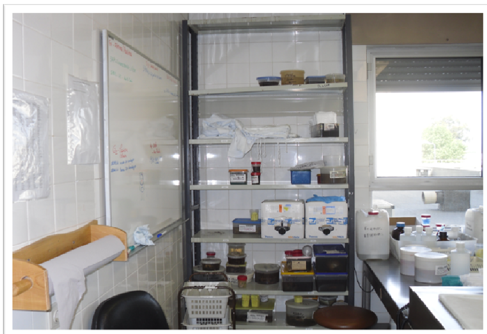
Figura 12 - Armário desprovido de ventilação/exaustão
