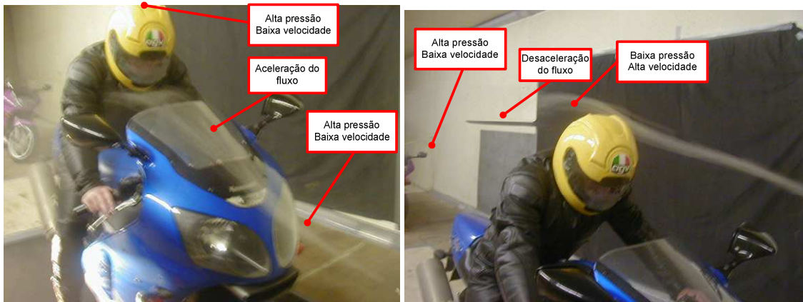
Figura 25. Pressão e velocidade num ensaio aerodinâmico. Fonte: [63] adaptado, p. 4.
