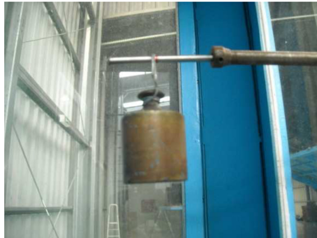
Figura 18 – Objecto de massa conhecida suspenso no TCO para calibração
