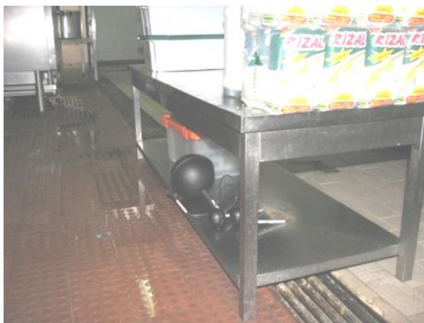
Fig. 5.4 - Colocação dos globos na cozinha antes da medição térmica
