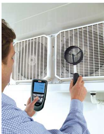
Figura 14. Medição de caudais.
