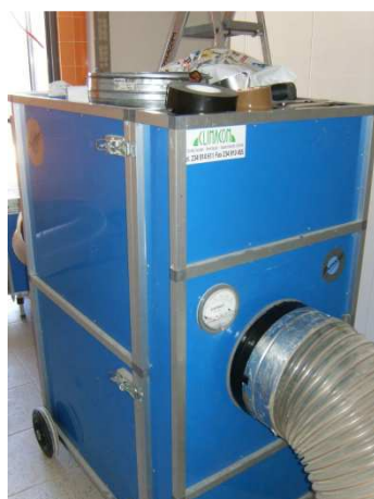
Figura 9. Módulo de filtragem
