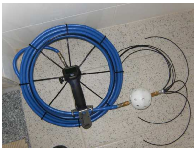
Figura 11. Equipamento utilizado na limpeza a ar comprimido.
