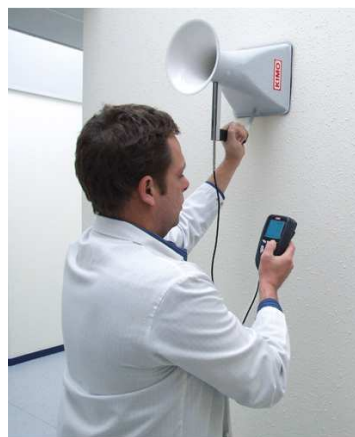
Figura 15. Utilização de cone de medição de caudal.
