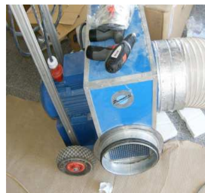
Figura 10. Ventilador para extração da conduta a ser limpa.
