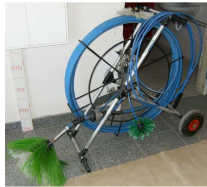
Figura 6. Escova rotativa acoplada na mangueira flexível para escovagem mecânica.
