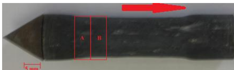
Figura 21. Fotografia do tubo de ensaio após o processo de compactação (A – Corte 1, B – Corte 2, Seta – Sentido da velocidade de detonação).
