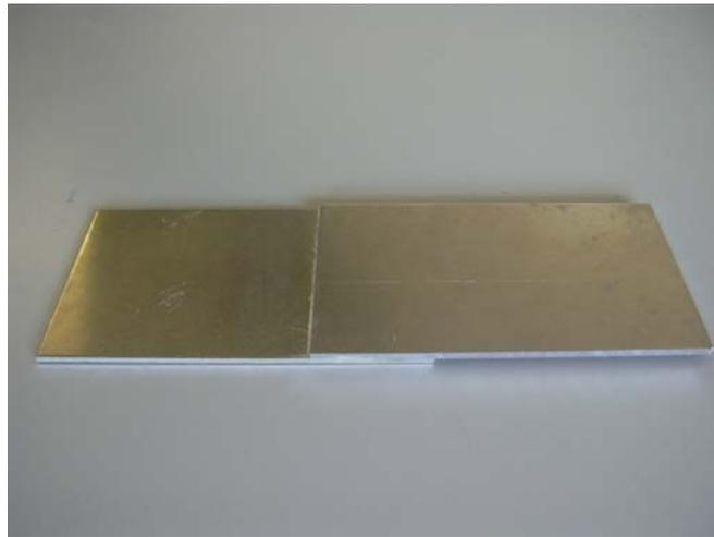
Figura 4.57 Exemplo de uma colagem tipo junta sobreposta em alumínio.
