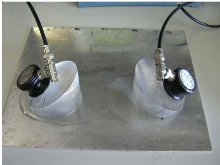
Figura 4.16 Transdutores e blocos de acoplamento.
