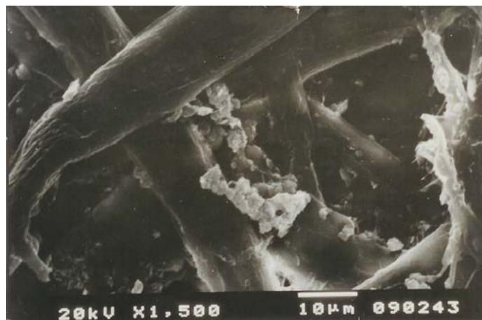
Figura 4.87 Imagem da microestrutura do papel obtida por *SEM*.
