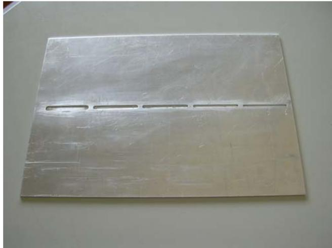
Figura 4.33 Conjunto de defeitos simulados com larguras variáveis e profundidade constante.
