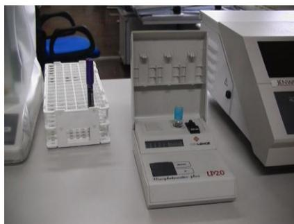
**Fig. 17** – *Medição do lactato no Mini-Espectrofotómetro, modelo Lp20, marca Dr. Lange*
