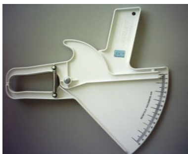
Figura 4. Adipómetro, marca SLIM GUIDE ® , com pressão constante de 10 g/mm 2 e precisão até às décimas de centímetro.
