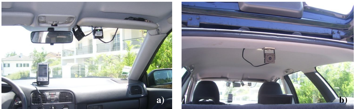
Figura 4.8 – Câmara frontal e lateral (a) e traseira (b)
