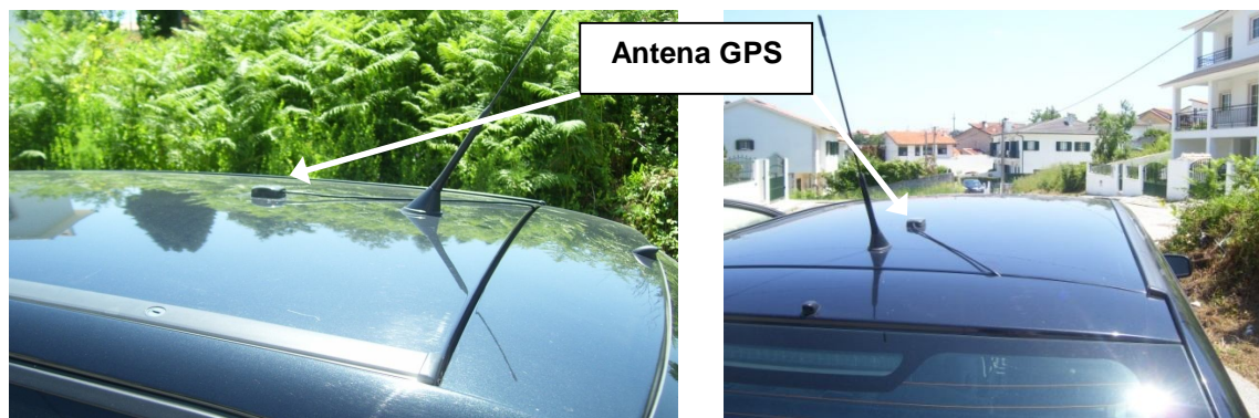
Figura 4.4 – Antena do GPS no tejadilho do veículo
