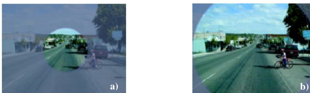
Figura 1.1 – Campo de visão de um condutor a diferentes velocidades: a) 65 km/h; d) 25 km/h (Hallmark et al., 2007)
