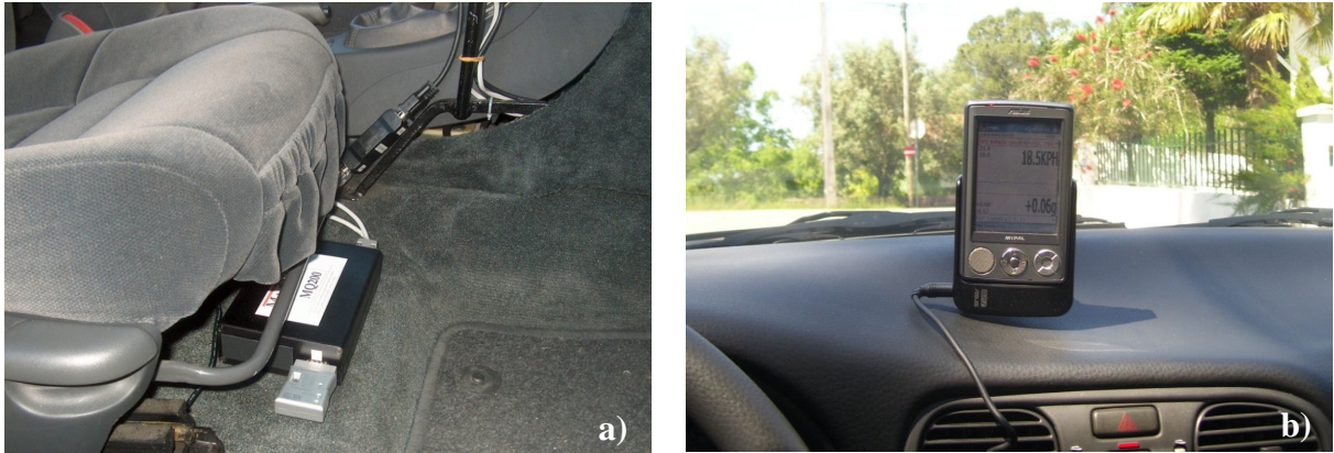
Figura 4.3 – Equipamento de recolha de sinais MQ 200RT montado no veículo (a) e PDA (b)
