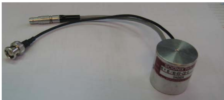
Figura 3.3 Fotodíodo CsI(Tl) usado no diagnóstico FEB.
