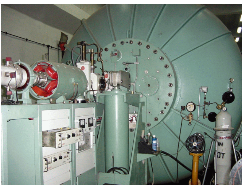
Figura 6.3:Tandem de Van der Graaf - IFIN HH.
