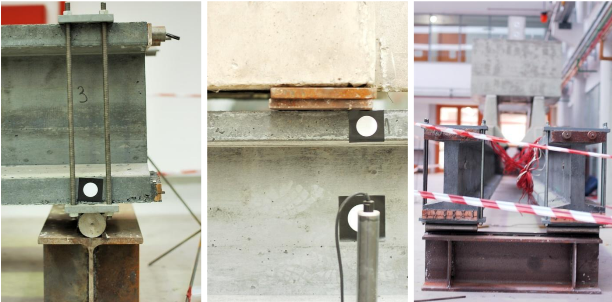
Figura 5.2: Pormenor do sistema de apoio e carregamento no ensaio de caracterização e avaliação do comportamento diferido
