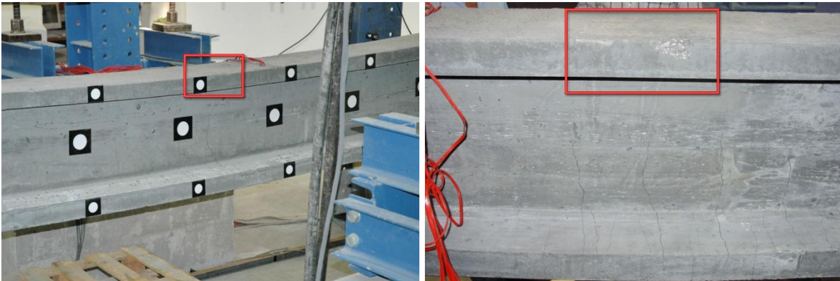
Figura 4.42: Esmagamento do betão nas fibras mais comprimidas antecipando o colapso
