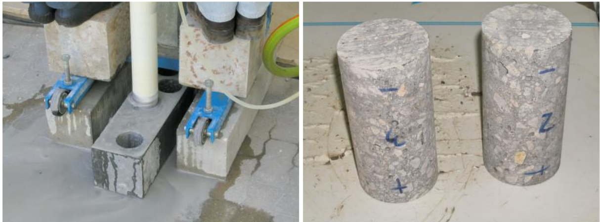
Figura 3.17: Extracção de carotes e aspecto dos provete após rectificação
