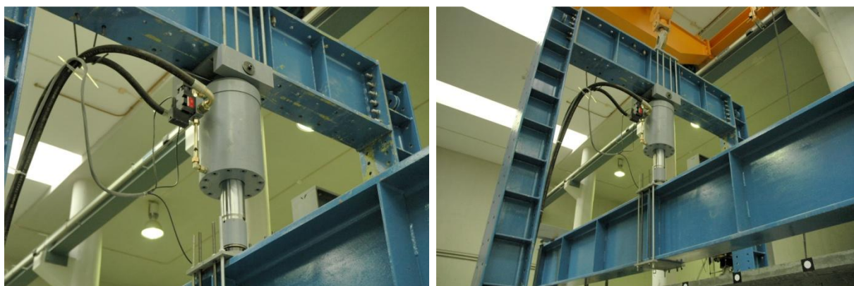
Figura 4.25: Actuador hidráulico, pórtico e viga de carregamento
