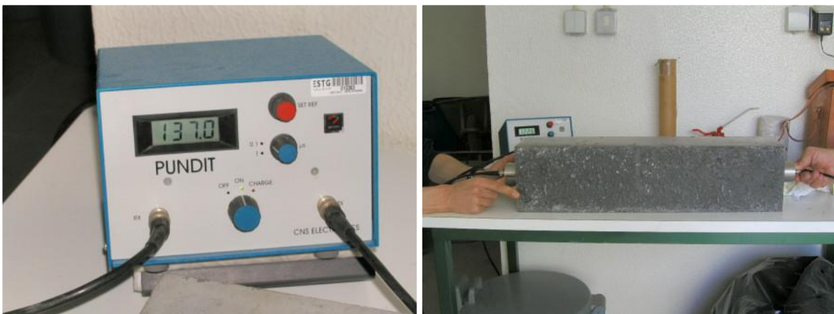
Figura 3.18: Ensaio da determinação da velocidade de propagação de ultra-sons
