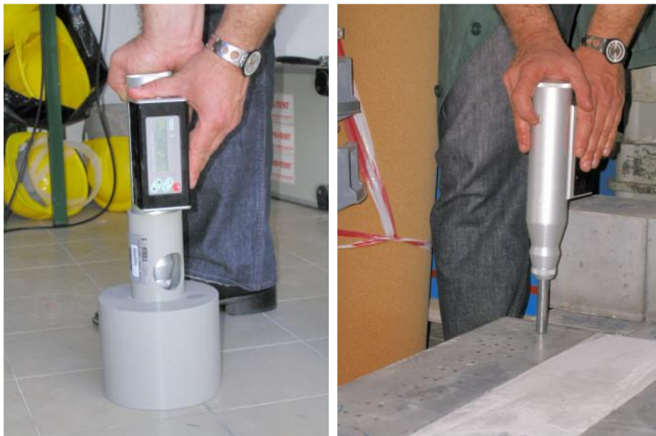
Figura 3.19: Calibração do equipamento e ensaio de determinação do índice esclerométrico
