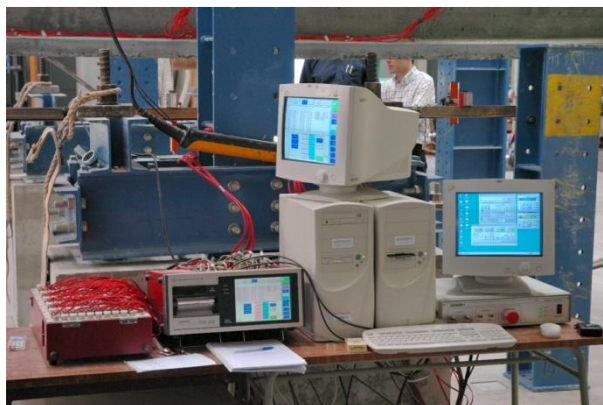
Figura 4.32: Sistema de aquisição, registo e controlo dos ensaios
