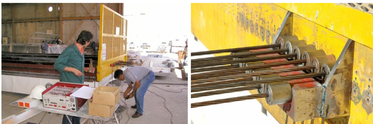
Figura 4.12: Verificação da tensão aplicada aos cabos de pré-esforço
