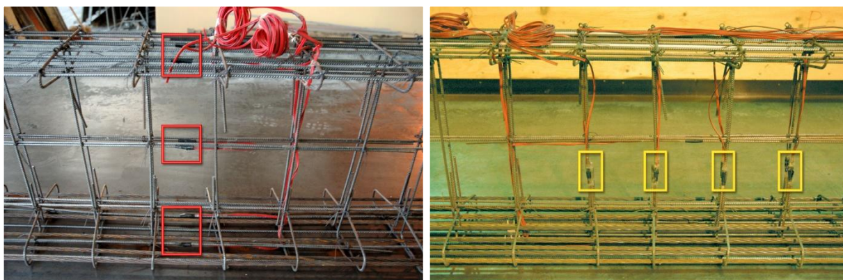
Figura 4.30: Extensómetros nas armaduras longitudinais e transversais
