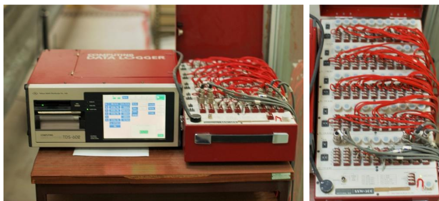
Figura 5.5: Sistema de aquisição e registo utilizado no ensaio de caracterização e avaliação do comportamento diferido
