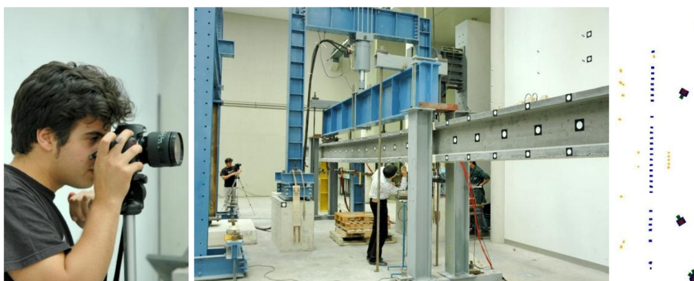
Figura 4.31: Aplicação de fotogrametria terrestre ao levantamento da deformada nos ensaios à rotura
