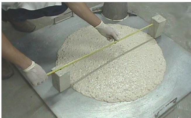
Figura 2.2: Ensaio de espalhamento de um betão auto-compactável branco [98]
