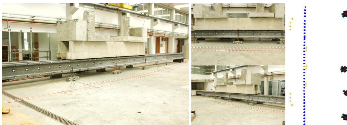
Figura 5.6: Aplicação de fotogrametria terrestre ao levantamento da deformada nos ensaios diferidos
