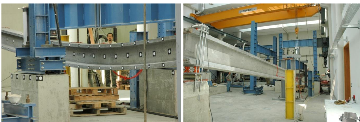
Figura 4.41: Deformada perto do colapso
