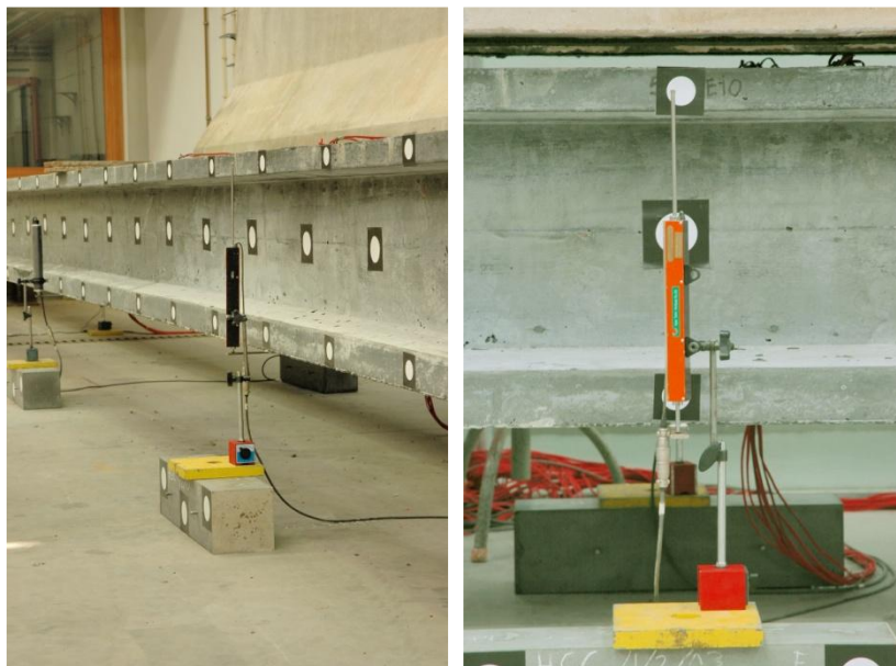
Figura 5.4: Transdutores de deslocamento para medição dos deslocamentos verticais no ensaio de caracterização e avaliação do comportamento diferido
