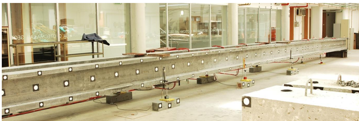
Figura 5.7: Instalação após colocação da instrumentação e antes de qualquer carregamento
