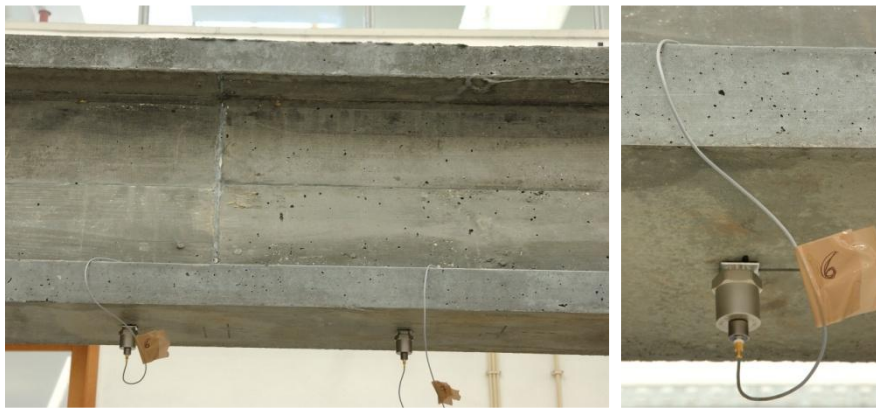
Figura 4.19: Fotografias ilustrativas do tipo e localização dos acelerómetros
