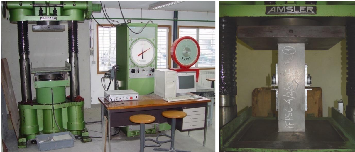
Figura 3.13: Conjunto associado à prensa AMSLER 500 TNF e provete para determinação do módulo de elasticidade
