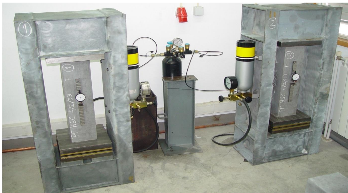
Figura 3.15: Máquinas de fluência com os provetes montados
