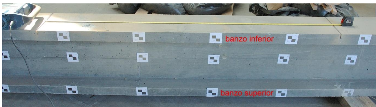
Figura 4.45: Seccionamento da viga para determinação do pré-esforço efectivo
