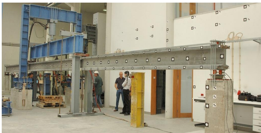
Figura 4.33: Aspecto da instalação no início dos ensaios à rotura
