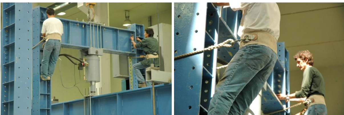
Figura 4.39: Fixação do pórtico na posição final do procedimento
