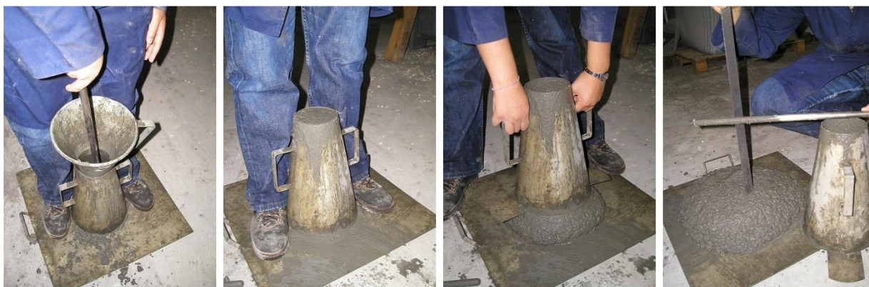
Figura 2.1: Ensaio de abaixamento do cone de Abrams
