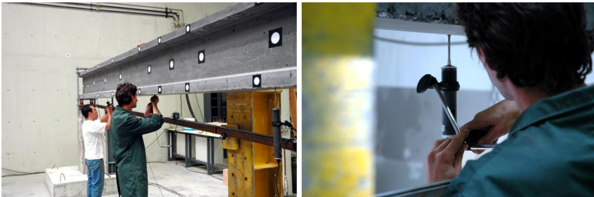
Figura 4.29: Transdutores de deslocamento para medição dos deslocamentos verticais
