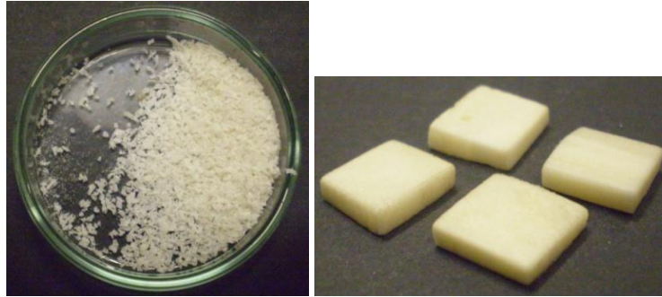
Figura 2.2 - Amostras de osso bovino preparadas no laboratório na forma de a) partículas de osso esponjoso; b) placas de osso cortical.
